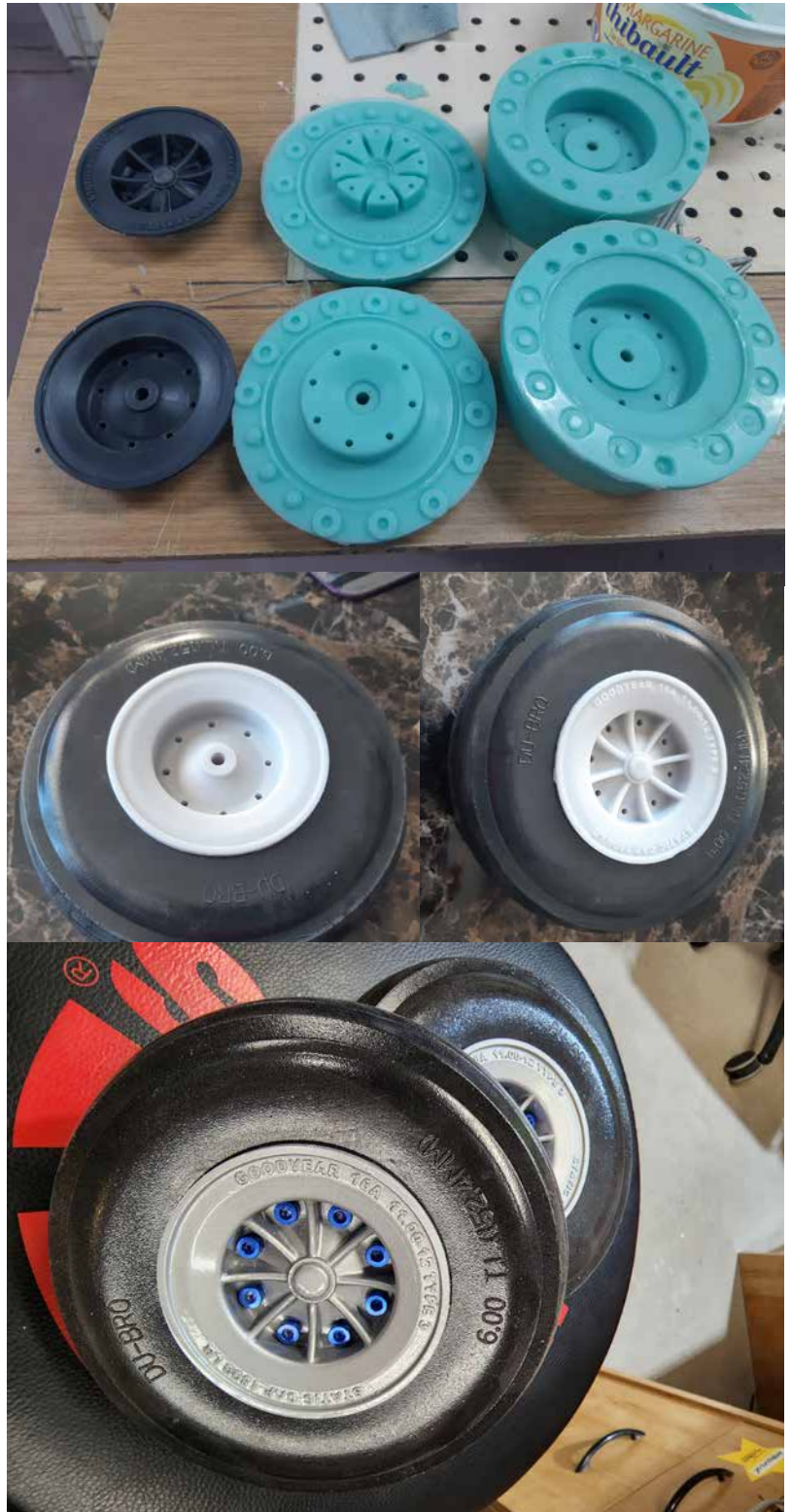
The black 3D printed parts are used to make the blue molds that are used to make the final parts. / Les pièces noires en 3D sont utilisées afin de fabriquer les moules bleus qui eux, serviront à fabriquer les composantes finales.
