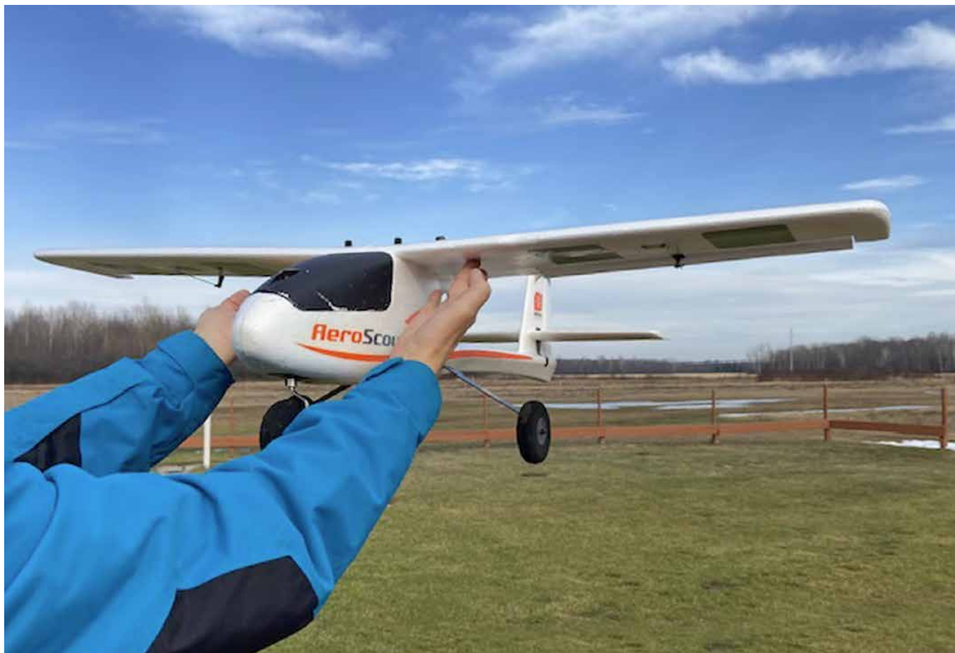
I am checking the balance at the field. The HobbyZone AeroScout wing has helpful CG markings. / Je vérifie le centrage sur place. Les ailes de l'AeroScout (de Hobby Zone) sont déjà dotées d'inscriptions pour le C.G.
