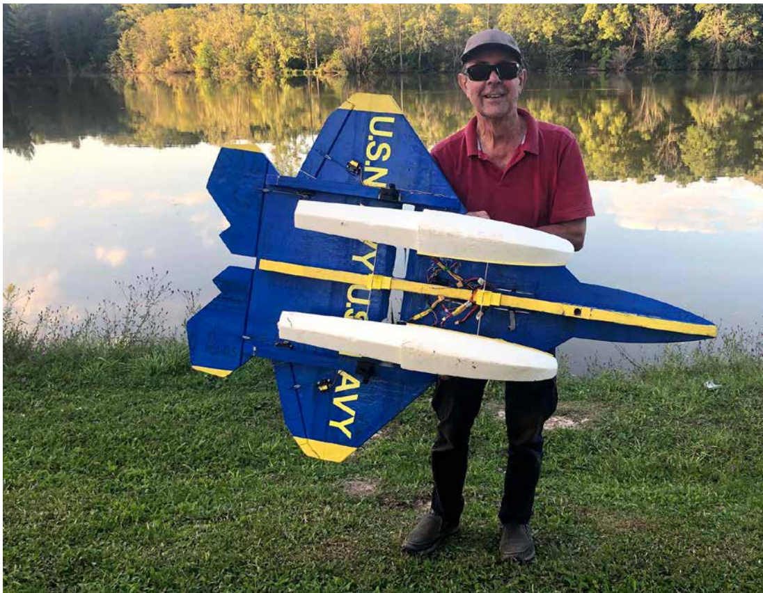
Completed F22 with the floats mounted using the 3D printed mounts / Photos du F-22 montrant les flotteurs installés grâce à des supports imprimés par 3D.
