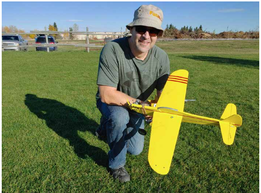
Jeff Sheppard of Beaumont, AB shows off his first attempt at a C/L Goodyear racer. This Shoestring built from a Sig kit is powered with a Gibeault-converted O.S. .15LA R/C engine. / Jeff Sheppard, de Beaumont (Alberta) exhibe son premier essai à assembler une maquette de type Goodyear racer pour le vol circulaire. Il a construit ce Shoestring à l'aide d'un kit Sig et a employé un moteur O.S. .15LA (télécommandé) converti par Gibeault.
