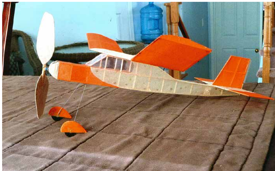
The Fat Prairie Bird has 1/4" deeper body for 1/2" blast tube." / Le Fat Prairie Bird possède un fuselage plus profond par 1/4 de pouce et est doté d'un tube à élastique de 1/2 pouce.
