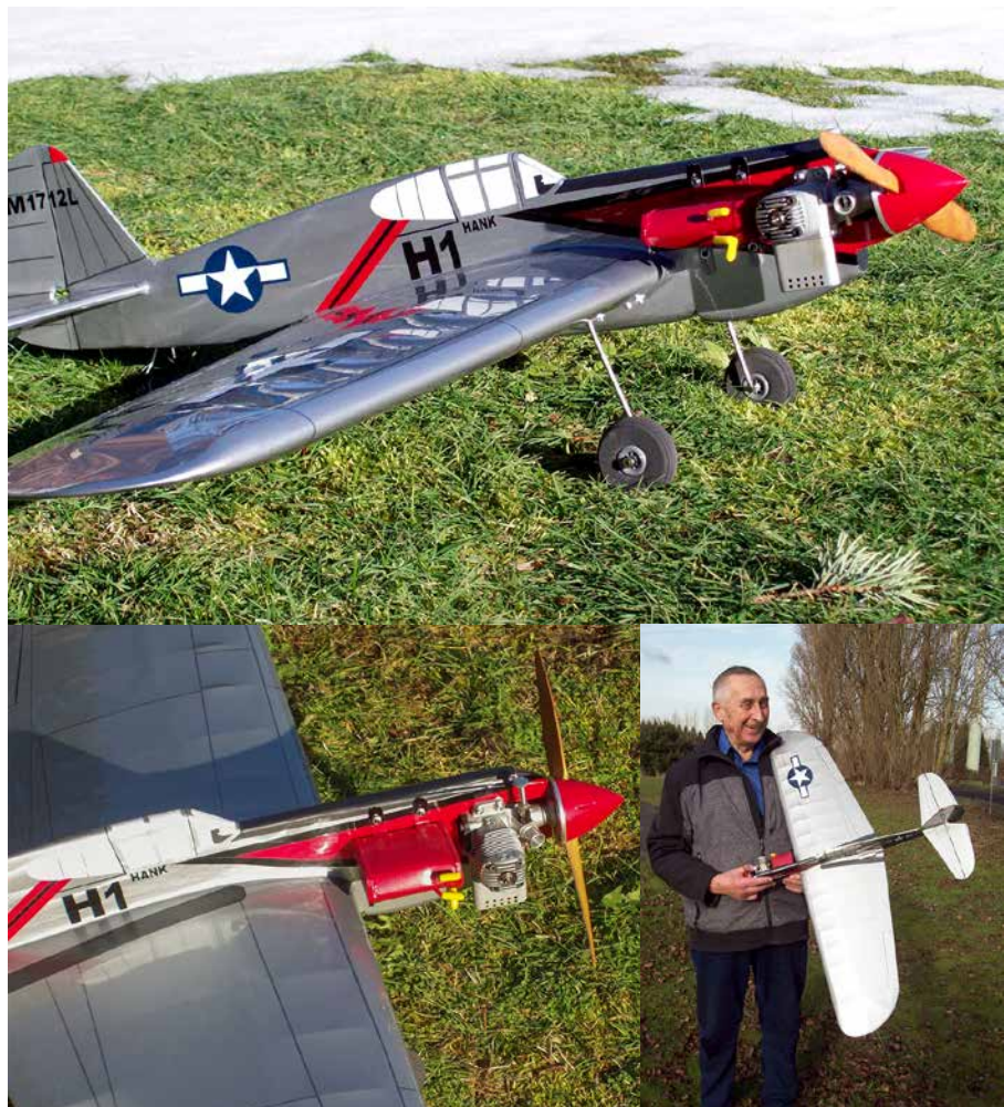
Larry Lewin of Abbotsford, B.C., built this P-40 Warhawk for his friend Henry Hajdik. The plane is built from a Carl Goldberg kit and powered by an O.S. .25LA. Covering is Monokote. / Larry Lewin (d'Abbotsford, Colombie-Britannique) a construit ce P-40 Warhawk pour son ami Henry Hajdik. La maquette a été réalisée depuis un kit du fabricant Carl Goldberg et est mûe par un OS .25LA. Le recouvrement est du Monokote. Photos by Larry Lewin
