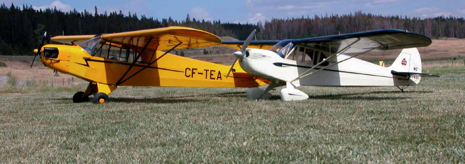
This 1/3 scale J-3 Piper Cub has a 12 ft (4-metre) wingspan and was built from (Canadian) Trillium Balsa Kit. / Ce Piper J-3 Cub possède une envergure de 12 pieds (4 mètres) et a été assemblé depuis un kit du fabricant canadien Trillium Balsa. Photo by Roly Worsfold
