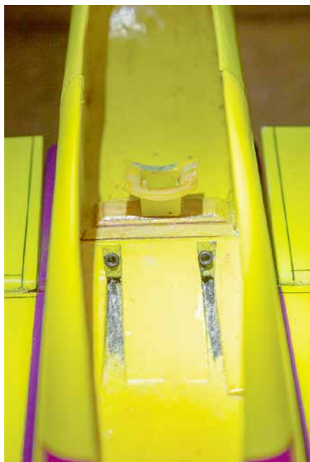
The F4/F5 rear wing mount sandwich. / Le sandwich des pièces F4 et F5 afin de monter la partie arrière des ailes.
