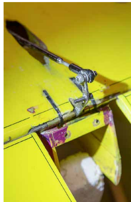
Full access to the flap horn! / On peut accéder au guignol des volets!
