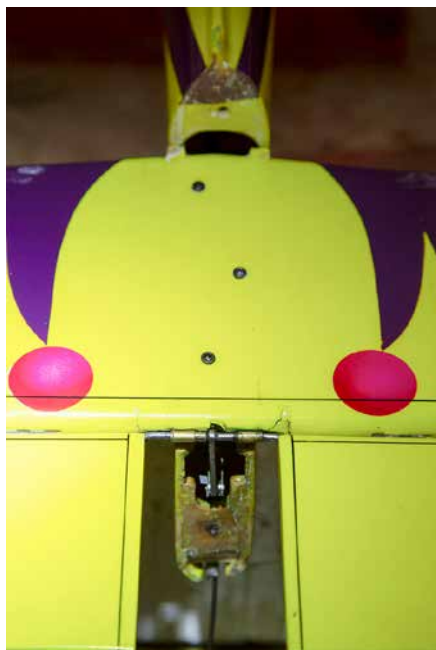
Notice the staggered bolt pattern of the stab mount bolts. / Notez le patron décentralisé des écrous pour monter le stabilisateur.
