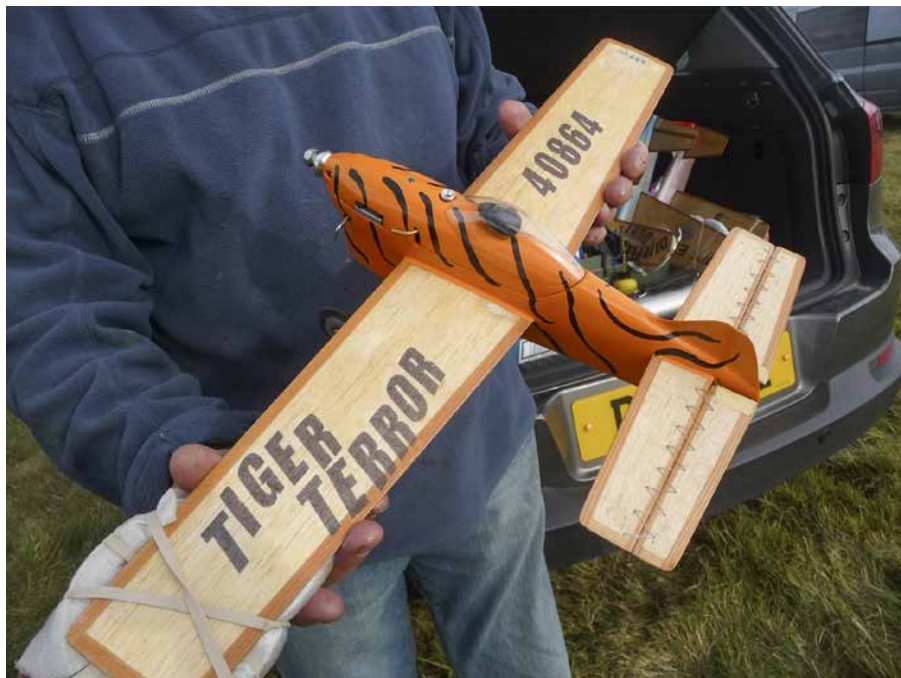
This Oliver Tiger MK IV-powered Vintage A "Tiger Terror" was a NATS finalist, pitted by Dave Finch at the 2015 British Nationals. Note the period-correct sewn hinges. / Un Tiger Terror (mû par un Oliver Tiger MK IV Vintage) qui est devenu un finaliste des épreuves NATS. Dave Finch s'est occupé de l'aire des puits lors des British Nationals de 2015. Notez les pentures cousues, conformes aux maquettes d'époque.
