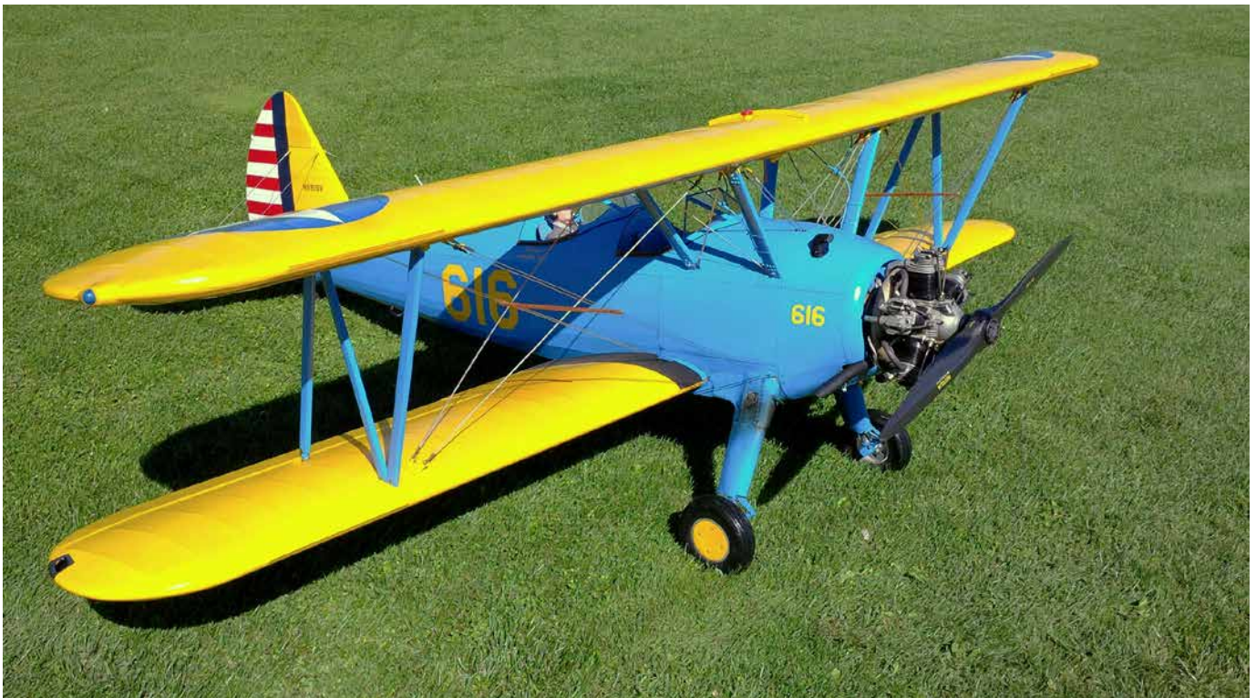
Karl Gross's Stearman. 1/3 size with a Moki 250 powered. / Le Stearman de Karl Gross. Échelle un tiers, mû par un Moki 250
