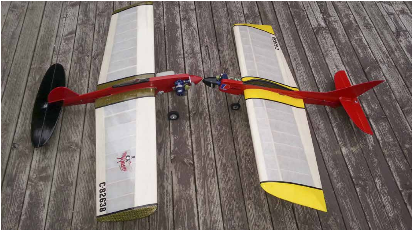
Left is the ubiquitous 1950 Matt Kania-designed Ringmaster flown the world over. Right is a George Aldrich designed 1957 Flite Streak. Old designs for sure, but good and rugged for training and sport flying. / À g., le Ringmaster mondialement connu qu'avait conçu Matt Kania en 1950. À dr., un Flite Streak (design de George Aldrich en 1957). Ces designs sont vieux, bien sûr, mais ils sont robustes pour la formation ainsi que le vol sportif et volent encore très bien.
