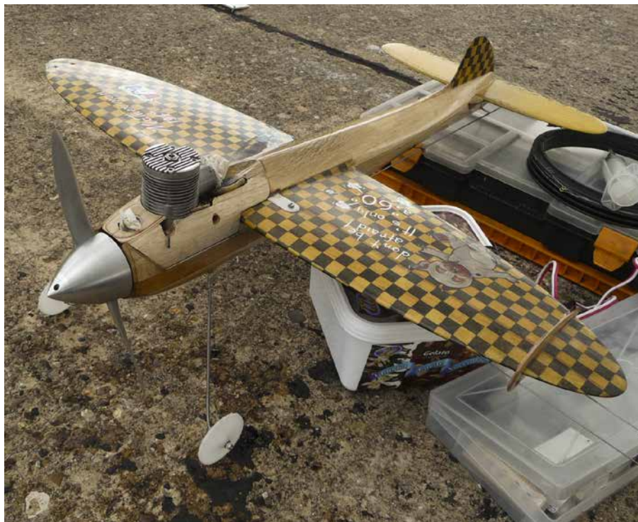
The largest Vintage speed class. This is a SuperTigre .60-powered Class 7 Vintage Weatherman Speed model. Flown (with no pylon) by Sal Angeloni of Italy. It pulls like a beast! / Voici la plus grande catégorie, Vintage speed. L'appareil illustré est une maquette Weatherman de vitesse de catégorie 7 (Vintage). Motorisation par un SuperTigre .60.
