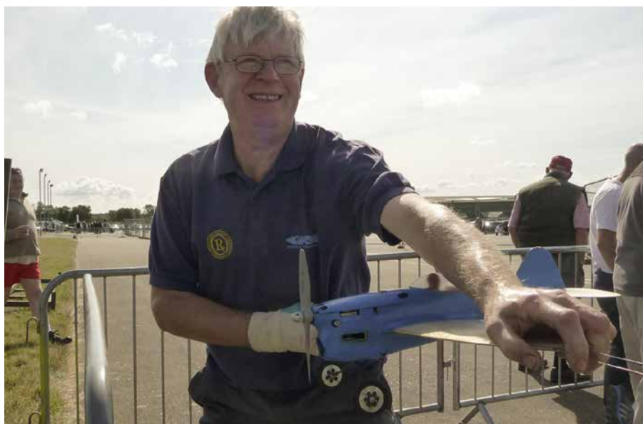
Dave Lewis pull tests his "Vintage Class B" Team Racer powered by the venerable Enya .29 side exhaust plain bearing engine. This is the largest of the vintage racing classes. a/ Dave Lewis effectue un test de « tire » sur les filins de son « Vintage Class B » Team Racer. Motorisation par un vénérable Enya .29 à échappement latéral (roulements simples). C'est la plus importante des catégories de maquettes antiques de course.
