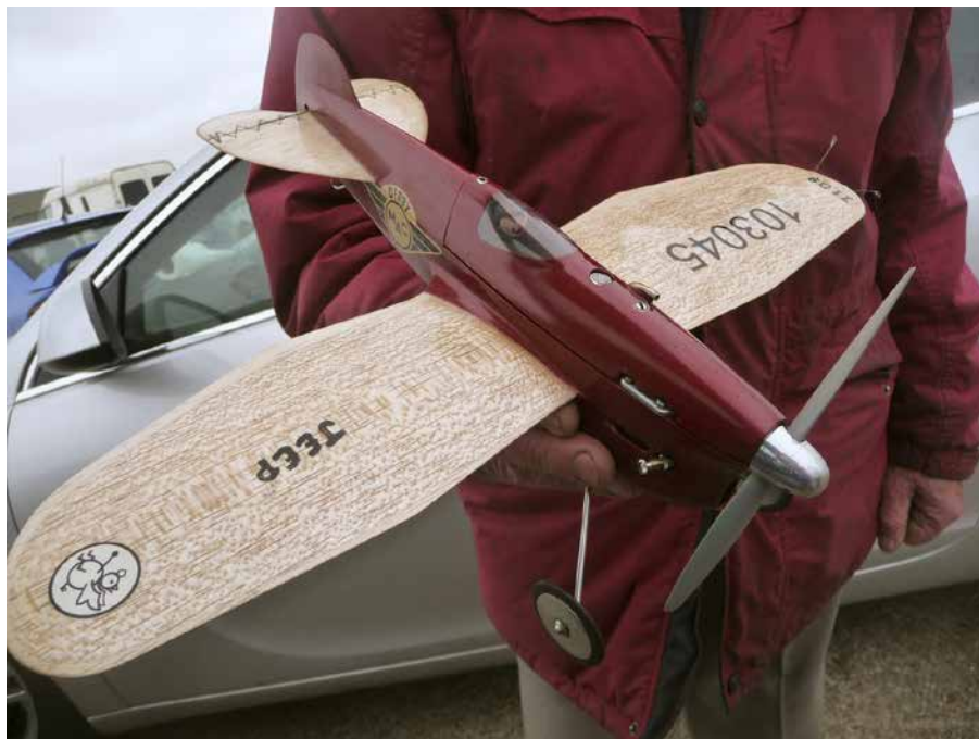
This superbly crafted 1.5cc-powered Oliver Cub Vintage 1/2A Team Racer was built and raced by Ken Nubold of England. This is the smallest racing class. / Voici un superbe 1/2A Team Racer (mû par un Oliver Cub Vintage de 1.5 c.c.) qu'a construit et piloté le Britannique Ken Nubold. Il s'agit de la catégorie des plus petites maquettes de course.
