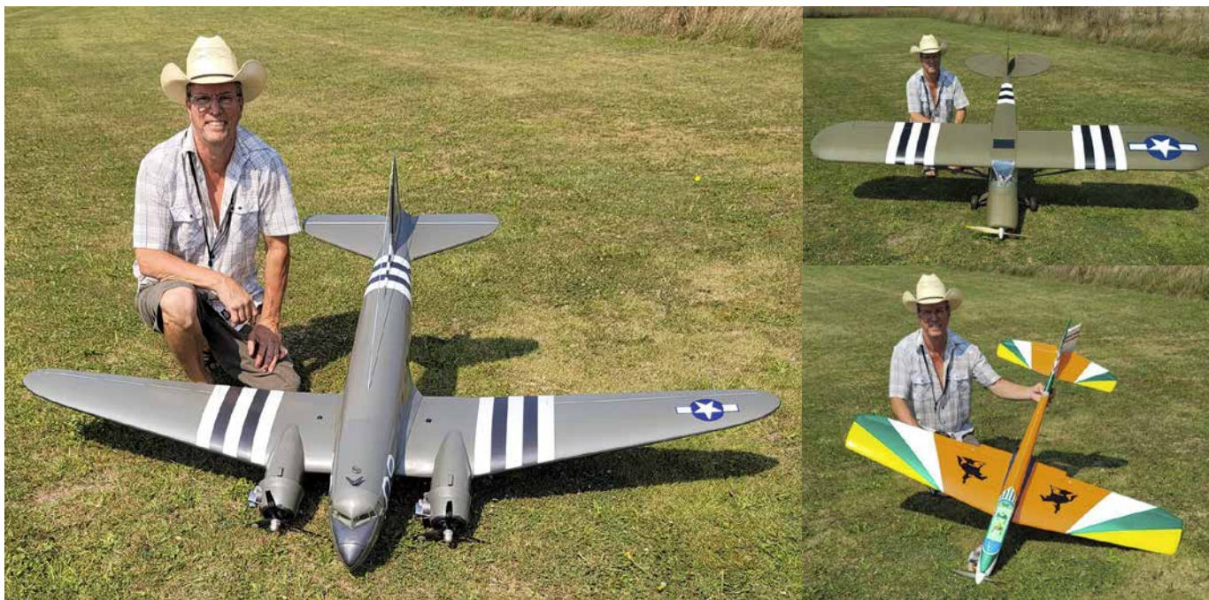
Club Napierville's Robert Lefebvre with his 84-inch DC-3, in military livery, powered by a Saito 56; his 1/4 scale Cub also with military livery, powered by Quadra 42 c.c. gas engine; and a Curare pattern competition plane powered by an O.S. .60 glow motor. / Robert Lefebvre (du Club de Napierville) et son DC-3 (envergure de 84 pouces et mû par un Saito 56) en livrée militaire; son Cub à l'échelle 1/4, aussi en livrée militaire (mû par un Quadra de 42 c.c.); et son Curare, un avion de voltige (mû par un O.S. .60).
