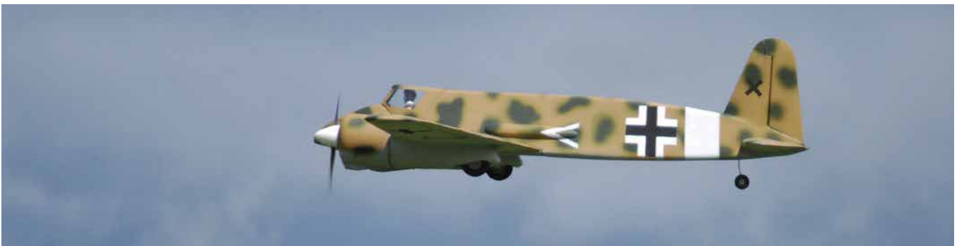
Andre Wedseltoft's Henschel 129 was scratch-built from a basic set of plans with extensive re-engineering to convert the wing from a foam core to a built-up wing. It is electric-powered with electric retracts, custom vacuum-formed canopy, and the cowls were acquired from Fibreglass Specialties. The finished airplane weighs 12 pounds. / Le Henschel 129 de conception artisanale d'Andre Wedseltoft depuis un jeu de plans très sommaire. Andre a transformé les ailes en construction conventionnelle de balsa (au lieu d'ailes en styromousse). La maquette est électrique et est dotée d'un train d'atterrissage escamotable. Le canopy a été formé sous vide tandis qu'Andre a acheté les capots moteurs chez Fibreglass Specialties. L'avion pèse 12 livres.
