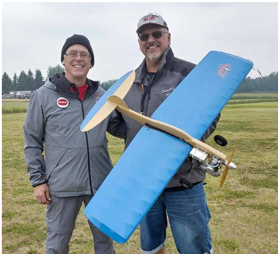
Kevin's gorgeous Tsumami is powered by a Cox TeeDee .049. Has enough power, but his tank still needs some sorting. / Le magnifique Tsumami de Kevin, mû par un Cox TeeDee 0,049. Il est suffisamment motorisé mais des soucis de réservoir demeurent à être résolus.
