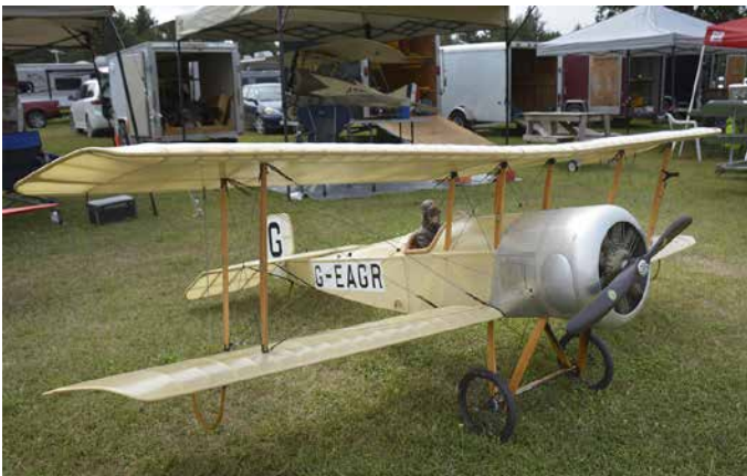
Brian Perkins' museum quality scratch-built Bristol Scout is powered by a well-disguised DLE-111 for power. / Le Bristol Scout de qualité muséale (et construit artisanalement) de Brian Perkins est mû par un DLE-111 bien "déguisé".
