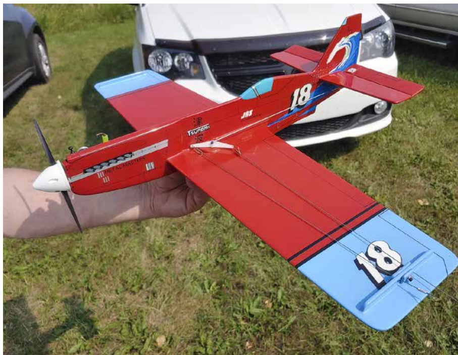
Kevin's gorgeous Tsumami is powered by a Cox TeeDee .049. Has enough power, but his tank still needs some sorting. / Le magnifique Tsumami de Kevin, mû par un Cox TeeDee 0,049. Il est suffisamment motorisé mais des soucis de réservoir demeurent à être résolus.
