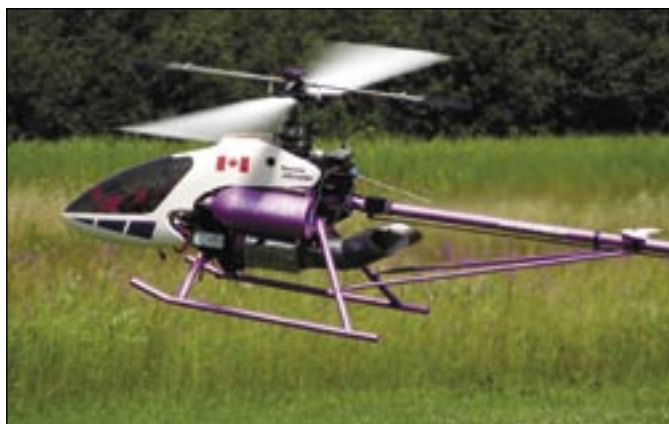
Don Dowe's Vario turbine heli with the Jet-Cat power system. / L'hélicoptère à turbine Vario de Don Dowe, muni d'un système Jet-Cat.
