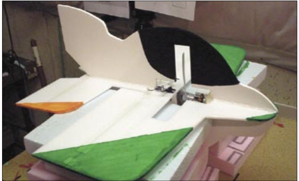
Art Lane's Sumo, powered by a 17gr outrunner. / Le Sumo d'Art Lane, mû par un moteur de type outrunner de 17 g.
