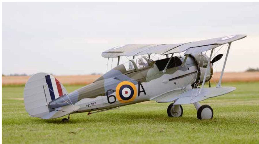
A Gloster Gladiator with a 6354-260kv swinging an 18x13,5x3 with 752p 2,300 mAh life batteries. / Un Gloster Gladiator muni d'un moteur 6354-260 kv fait tourner une hélice de 18 x 13,5 x 3 grâce à une batterie Life de 2 300 mAh.
