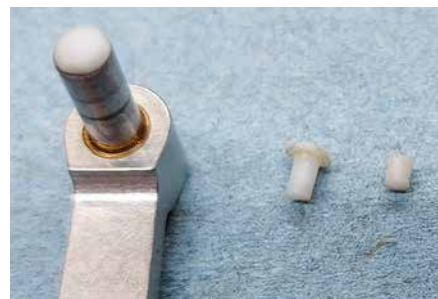
This shows both the broken pad, the remade pad and the installation of the pad in the wristpin. / Cette photo montre le coussinet endommagé et celui que j'ai fabriqué ainsi que l'installation du coussinet dans le maneton.
