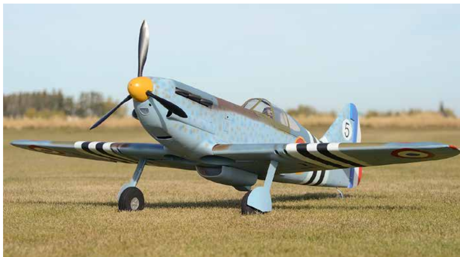
This 71-inch Dewoitine 520, powered by an E-Flite 160 245kv swinging an 18x18x3 running 8s2p 2,300 mAh life battery. / Ce Dewoitine 520 - d'une envergure de 71 pouces - est mû par une batterie Life de 2 300 mAh, 8s2p.
