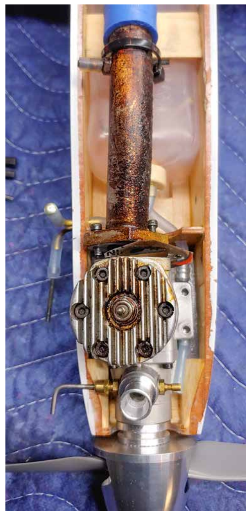
Wow! Those engine header pipes sure get covered in baked-on oil! / Wow! Ces collecteurs sont recouverts d'huile qui a cuit sur place!
