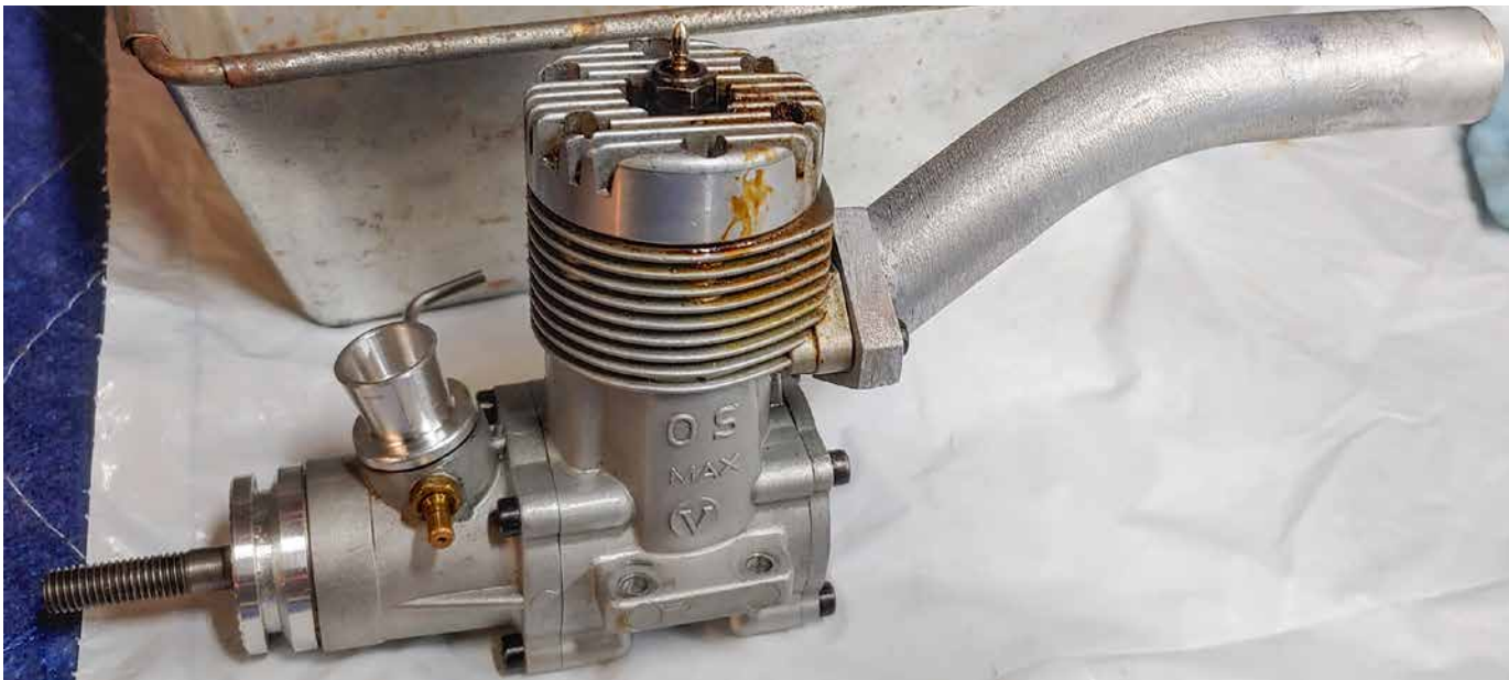
Clean as a whistle after an overnight soaking in rust remover and a toothbrush. / Le moteur est tout propre après l'avoir fait tremper dans la solution antirouille et avoir frotté à la brosse à dents.
