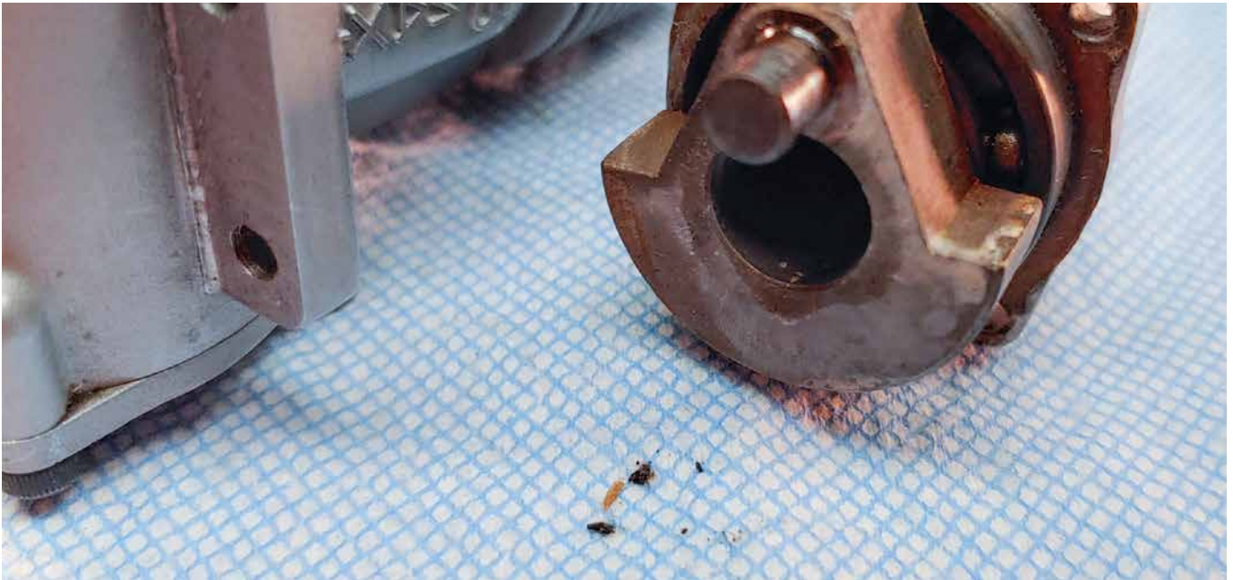
Yes indeed, just some of the FOD removed from this crank assembly using a long “Q-tip”. / Oui, en effet, voici une partie des saletés que j’ai enlevées de cet assemblage de vilebrequin à l’aide d’un long « Q-tip ».
