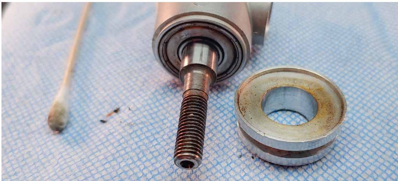
With the driveplate removed, there is yet more evidence of dirt and corrosion. This is all cleaned up and re-oiled prior to re-assembly. / Une fois que j'ai retiré la plaque d'entraînement, j'ai constaté la présence de saletés et de corrosion. J'ai tout nettoyé et huilé avant d'assembler le tout.
