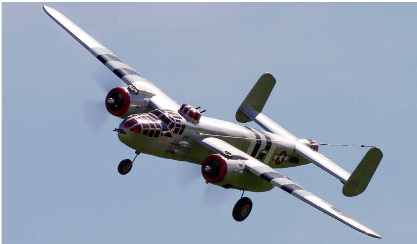
A gorgeous 72-inch span B-25 Mitchell on final approach. The model is powered by 2 OS 555, uses 12 servos, and includes an operating bomb bay. The model can drop four marshmallows, each with four-foot streamers. / Un magnifique B-25 Mitchell en approche. Envergure de 72 pouces, motorisation par le biais de 2 O.S. 55, 12 servos installés et soute à bombes fonctionnelle. Cette maquette peut larguer quatre guimauves enrobées de banderoles de quatre pieds. PHOTO: Mario De Rocco #4254
