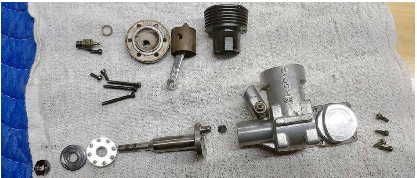
Once disassembled, the individual parts have been cleaned, de-coked and inspected for flaws. I'd love to know what Dick McCoy was thinking with some of these rather unusual design features in the head. / Une fois le moteur démantelé, les pièces ont été nettoyées, libérées des résidus de carbone et inspectées pour y déceler la moindre fissure. J'aimerais donc savoir à quoi pensait Dick McCoy lorsqu'il a incorporé ces caractéristiques inédites à la tête du moteur.
