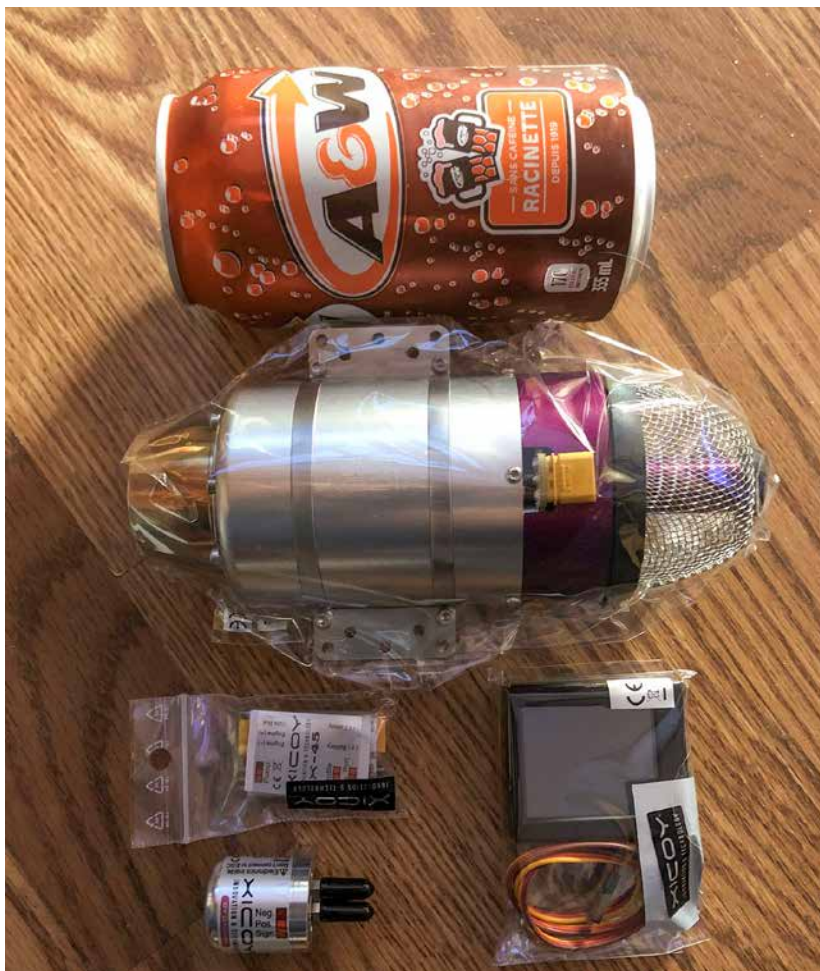
The 10 lb Gaspar X45 turbine for the RetroM. / La turbine Gaspar X45 (10 livres) pour le RetroM.
