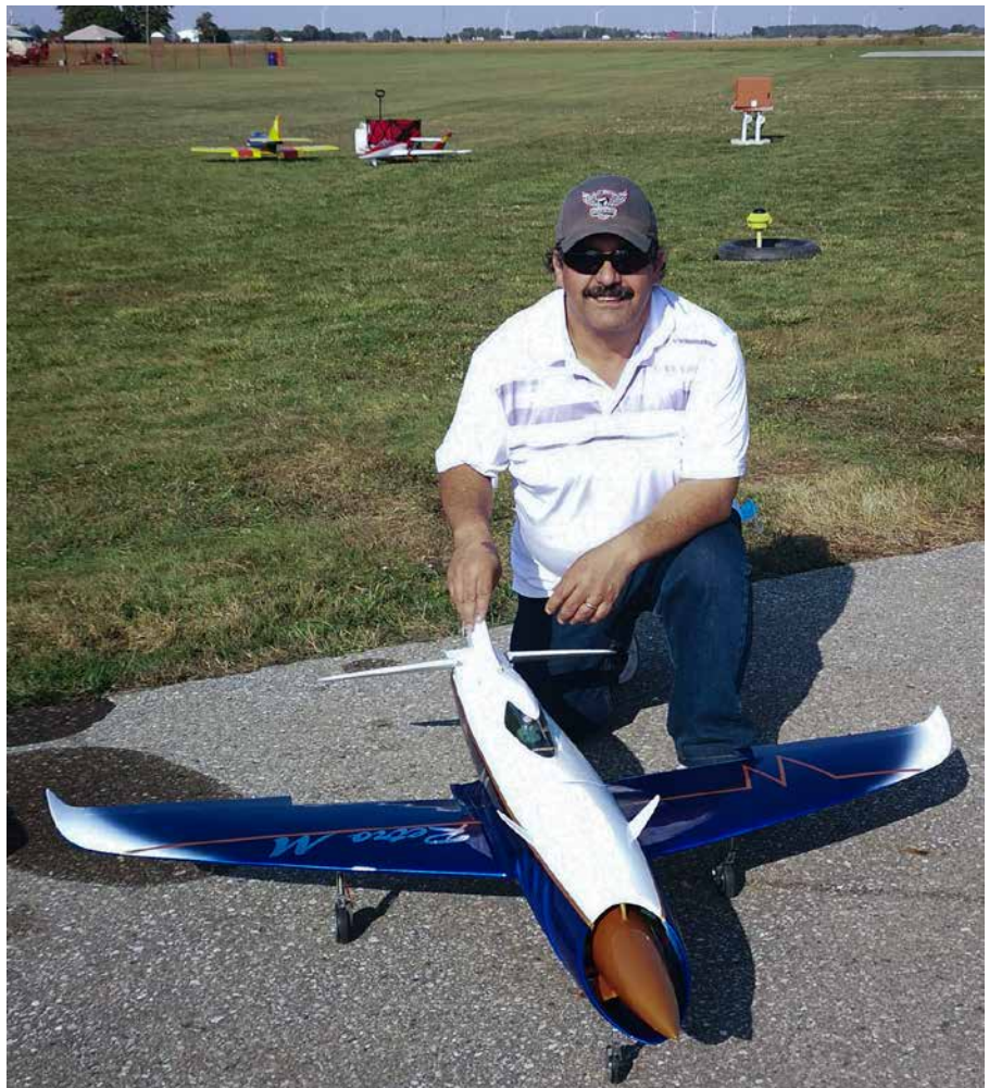
Paul Sousa poses with his RetroM by Mugu Models, 1500mm span, a 10 lb thrust Gaspar X45 turbine./ Paul Sousa et son RetroM. Produit de Mugu Models : envergure de 1 500 mm, mû par une turbine Gaspar X45 de 10 livres.
