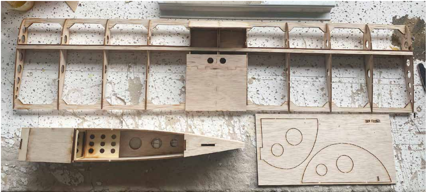
The 24" span, sub 250g Willy Nillies DerFlugel flying wing on the building bench. / L'aile volante DerFlugel (un produit de Willy Nillies) à l'atelier. Envergure de 24 pouces, poids de moins de 250 grammes.
