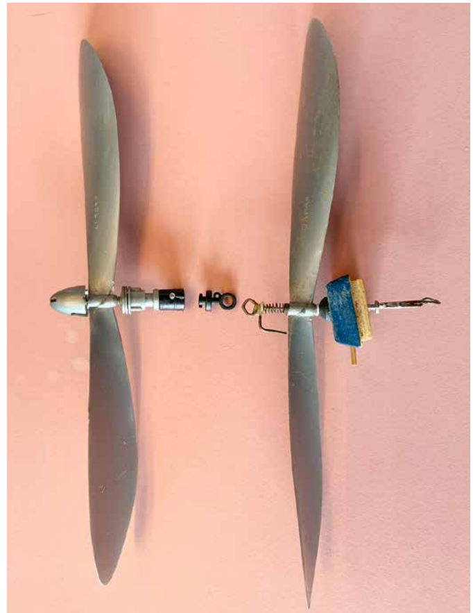
Propellers: Gizmo Geezer on the left. Homemade on the right. / Hélices : Gizmo Geezer sur la gauche. Hélice ‘maison’ sur la droite.
