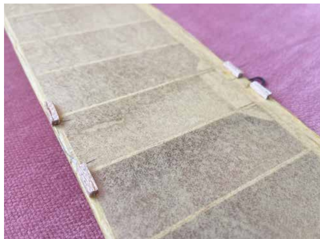
All flying surfaces need small tabs for alignment. / Toutes les gouvernes sont munies d'une petite languette afin de faciliter l'alignement.
