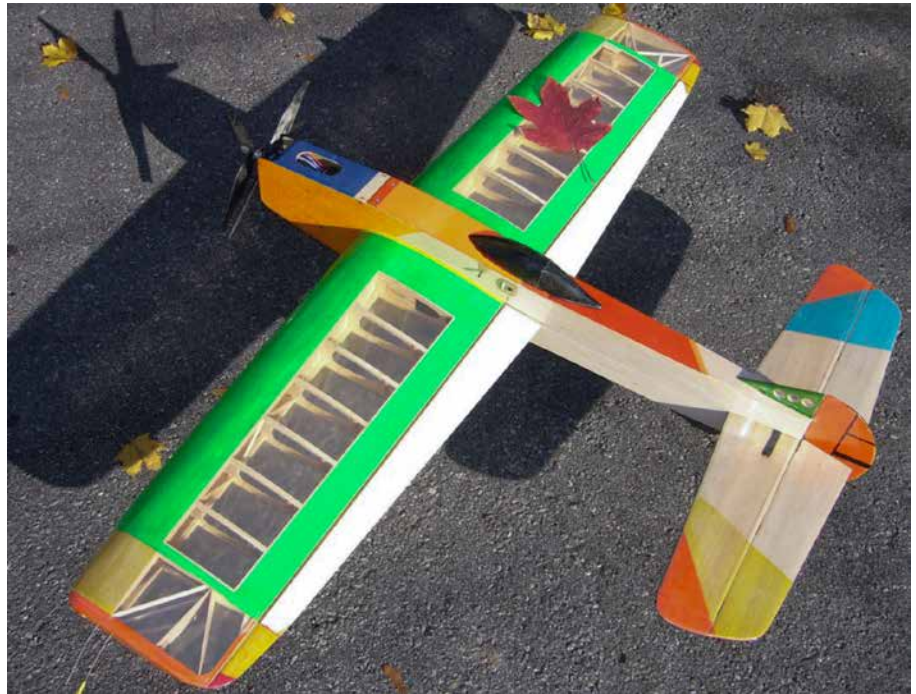
Matt Piatkowski's eParrot XL electric control line stunt model with contra rotating props. / La maquette de vol circulaire électrique eParrot XL de Matt Piatkowski, munie d'hélice contrarotatives.
