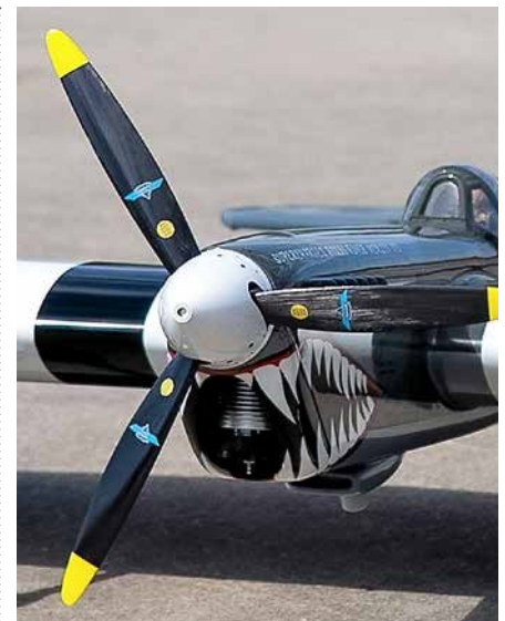
.67 long stroke nestled in the nose. / Le RoJett .67 à course longue dans le nez de l'appareil.
