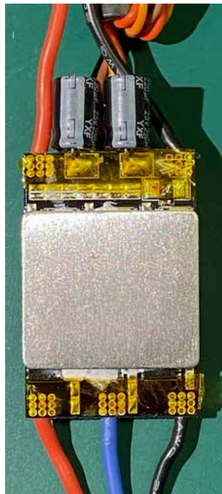
What's under the heat shrink? On one side you can see the two battery wires, three motor wires, the twisted cable that plugs into the throttle channel on the receiver, and the electrical components. On the other side is the aluminum plate that acts as a heat sink for the power transistors. / Qu'est-ce qui se trouve sous la pellicule thermorétractable? D'un côté, on voit les deux fils de batterie, les trois fils du moteur, le câble entortillé qui se branche dans la voie des gaz sur le récepteur ainsi que les composantes électriques. De l'autre côté se trouve la plaque d'aluminium qui diffuse la chaleur des transistors.
