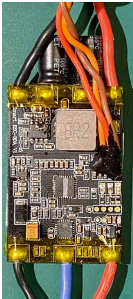
What's under the heat shrink? On one side you can see the two battery wires, three motor wires, the twisted cable that plugs into the throttle channel on the receiver, and the electrical components. On the other side is the aluminum plate that acts as a heat sink for the power transistors. / Qu'est-ce qui se trouve sous la pellicule thermorétractable? D'un côté, on voit les deux fils de batterie, les trois fils du moteur, le câble entortillé qui se branche dans la voie des gaz sur le récepteur ainsi que les composantes électriques. De l'autre côté se trouve la plaque d'aluminium qui diffuse la chaleur des transistors.
