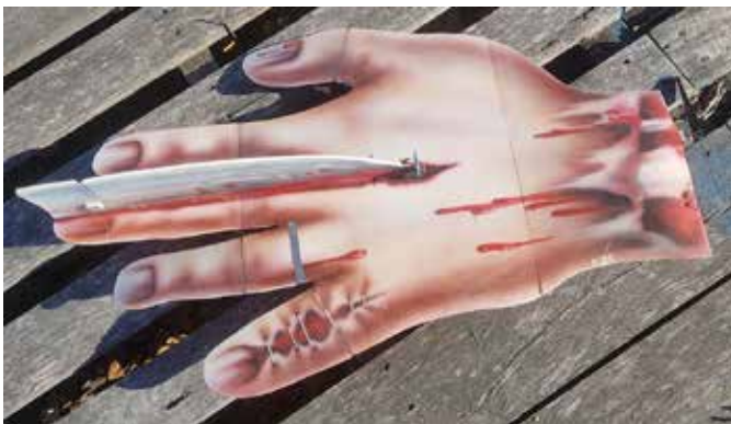
Xavier designed the flying hand for a Halloween festival. It's made of Depron and the fingers are elevons. The knife blade serves as a vertical fin and rudder. Turnigy 2S350 Lipo battery, 2204 motor and 6A ESC. / Xavier a conçu la main volante à l'occasion d'un festival de l'Halloween. Celle-ci est faite de Depron et les doigts sont en fait des élevons. La lame de couteau sert de dérive verticale et de gouvernail de direction. Moteur 2204 jumelé à une batterie Li-Po 2S350 de Turnigy et à un contrôleur de vitesse de 6 ampères.
