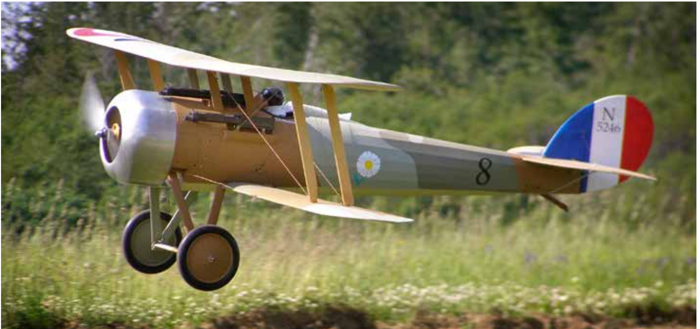
Xavier finished this 1/4 scale Proctor Nieuport 28 with Solartex and latex paint applied with a brush. It has an AXI 5320 with a 20x10 APC propeller running on 8S5000 Lipo. JR radio and servos. Total weight 7 kg (15,5lbs). Photo by Paul Grenier, taken at the Amidair club field. / Xavier a recouvert son Nieuport 28 à l'échelle 1/4 à l'aide de Solartex et de peinture au latex qu'il a appliqué avec un pinceau. Moteur AXI 5320 jumelé à une hélice APC 20 x 10 et une batterie Li-Po 8S5000. L'émetteur et les servos sont de JR. Poids total : 7 kg (15,5 livres). Photo de Paul Grenier, prise au terrain du Club Amidair.
