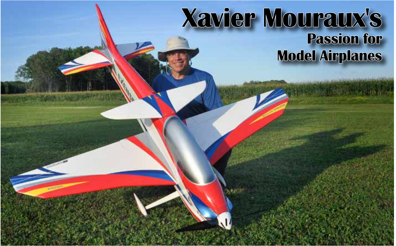
Xavier and his BJ Craft Essence F3A airplane with Plettenberg Advanced 30-10 motor, Falcon 20,5x13,5 prop, JR radio and servos, Jeti Mezon ESC and 10S5000 Lipo batteries. Total weight 4.8kg (10.6lbs). / Xavier et sa maquette de F3A BJ Craft Essence, mûe par un Plettenberg Advanced 30-10, hélice Falcon de 20,5 x 13,5. Émetteur et servos JR, contrôleur de vitesse Jeti Mezon et batteries Li-Po 10S5000.
