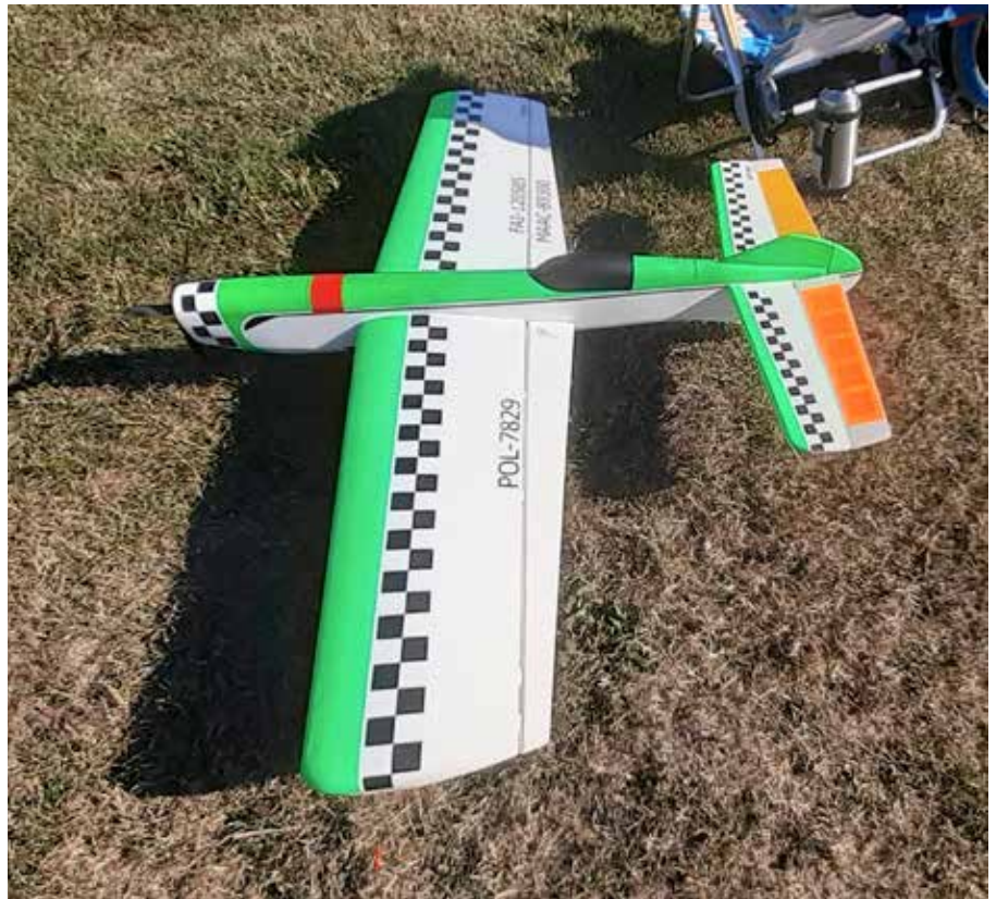
Matt Pietkowski's attractive electric control line stunter. He had it built for him in Poland, and it has proved to be a great flier. Wingspan is 60 inches, approximate weight is 55 ounces. / L'attrayant avion de vol circulaire acrobatique de Matt Pietkowski, à propulsion électrique. Il l'a fait construire en Pologne et c'est une maquette qui vole très bien. Envergure de 60 pouces, poids approximatif de 55 onces.
