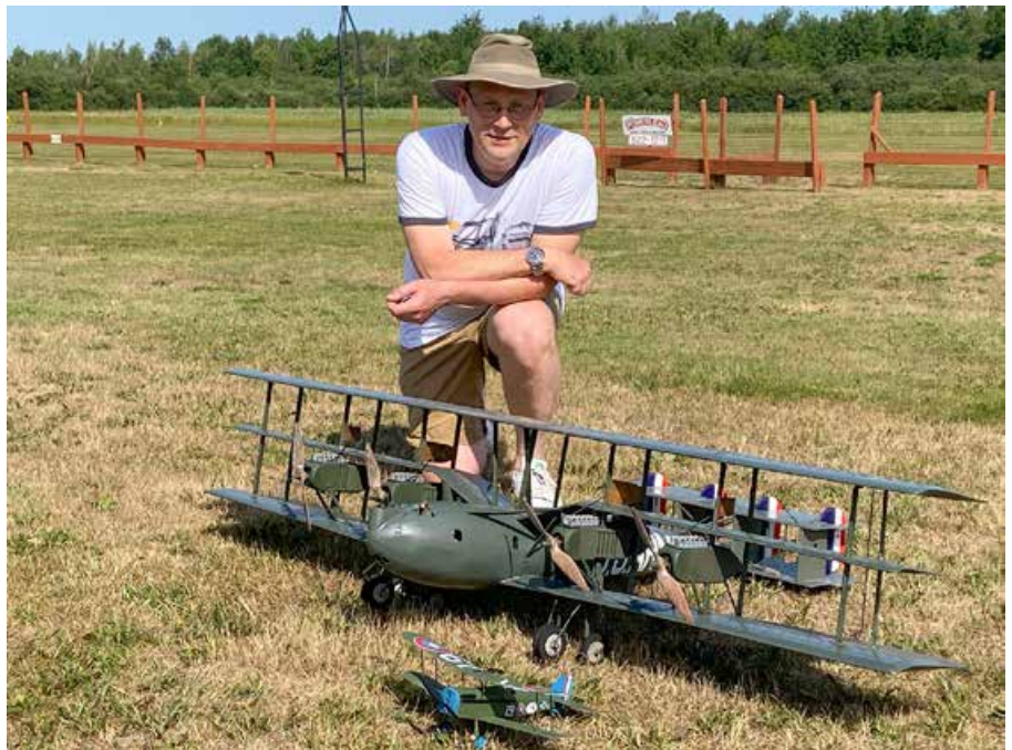
Jon Harper of the Stetson Flyers in Ottawa with his 1/20 scale own-design 1922 Barling Bomber. The model is 72" span (1.8m) and weighs 8lb (3.6kg). The little SE5a is to the same scale as the Barling. The model flies very well but requires careful piloting. Only one example of the prototype was built, and it achieved a top speed of 95 mph. / Jon Harper des Stetson Flyers (Ottawa) et son Barling Bomber de sa propre conception (échelle 1/20) datant de 1922. La maquette possède une envergure de 72 pouces (1,8 mètre) et pèse 8 livres (3,6 kg). Le petit SE5a est à la même échelle que le Barling. La maquette vole bien mais le pilotage en demeure pointu. Seul le prototype du Barling a été construit et il était capable d'une vitesse maximale de 95 milles à l'heure.
