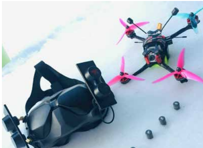
HD Digital Video installed on a drone using TrueRC Canada antennae for a solid video link with increased range, matched with DJI FPV goggles. / Un système vidéo HD est installé sur un drone et une antenne TrueRC Canada retransmet une liaison vidéo très solide, en partie grâce à des lunettes de vol par immersion (FPV) DJI. La portée s'en trouve aussi améliorée.
