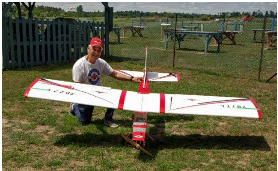
Steve Woloz with his Skyward 120. The 110" span model comes in at 24 lbs and is powered with a SV 32cc motor. / Steve Woloz et son Skyward 120. La maquette d'une envergure de 110 pouces pèse 24 livres et est mûe par un SV de 32 cc.
