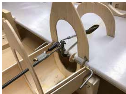
Detail shot of the Walker flap adjuster. / Photo du détail de l'ajusteur de volets Walker.
