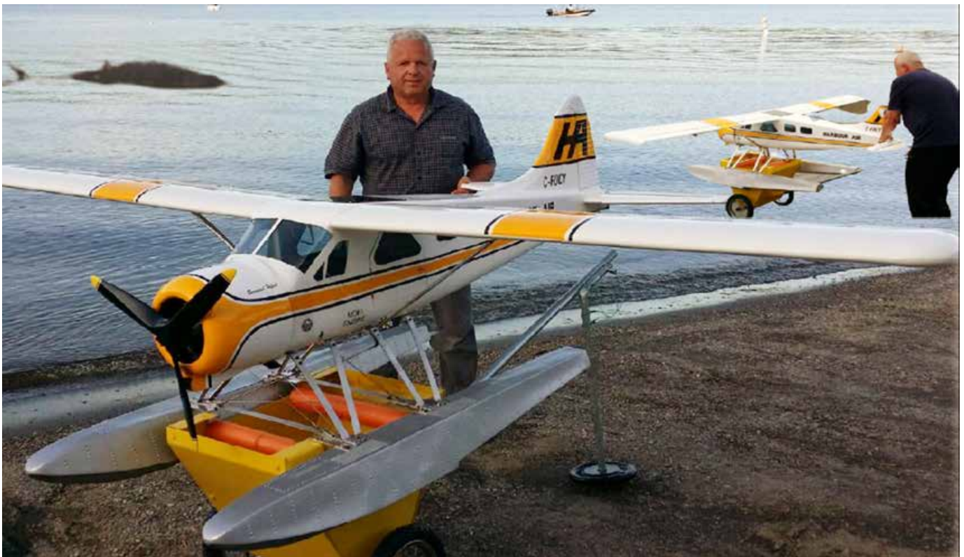
A beautiful scale DHC-2 Beaver with a MOKI 150 engine. It is done up in one of Vancouver's Harbour Air aircraft. / Une magnifique copie volante du DHC-2 Beaver, avec moteur MOKI 150. Bernard a reproduit la livrée de l'un des appareils de Harbour Air, à Vancouver.
