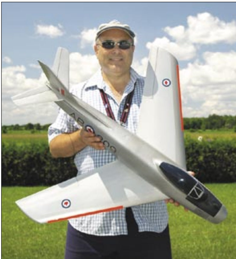
Rob Brun Del Re is all smiles on Canada Day after his first flight on this Scott Black original F86 Sabre EDF prototype made of blue foam and brown paper. Powered by a Mega 22-20-4 motor and 7 x A123 cells driving a modified WMT 609 fan. / Rob Brun Del Re sourit de toutes ses dents, le 1er juillet, après avoir procédé au vol inaugural du prototype du F86 Sabre qu'avait construit Scott Black. La maquette de type ducted fan électrique a été réalisée à l'aide de polystyrène bleu. Elle est mûe par un Mega 22-20-04, un assemblage WMT 609 modifié et par sept piles A123.
