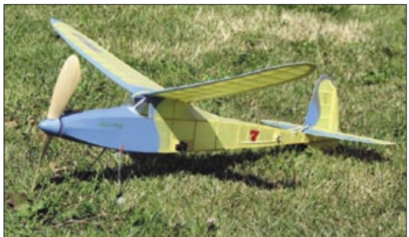
A very nicely built 'Sparky' by Steve Walther. Freewheel system is hidden very neatly within the spinner. / Un bien beau Sparky de Steve Walther. Le système de volant (freewheel) est dissimulé à l'intérieur de la coupole d'hélice.
