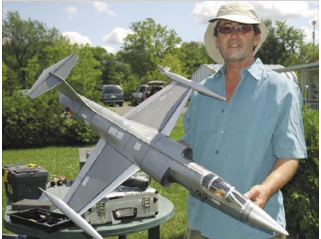
Jean-Claude Terrattaz shows off his HET F104 EDF powered by 4s 3300 Fullymax Lipos driving a 70 mm HET fan for eight-minute flights at scale speeds. / Jean-Claude Terrattaz sa maquette électrique HET F104 de type ducted fan, mûe par un assemblage HET de 70 mm et des piles Li-po Fullymax 4s 3300, ce qui confère à l'intercepteur une durée de vol de huit minutes à une vitesse très réaliste.
