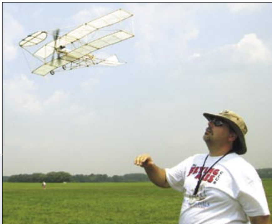
Ronnie Gosselin of Montréal, is captured at Geneseo launching his 1908 'Ferber Type 8', 32" span, contra-rotating propellers and weighing 63 gms with motor. A challenging subject well executed. / Ronnie Gosselin, de Montréal, a été croqué à Geneseo en train de lancer son Ferber type 8 1908. Cette maquette a une envergure de 32 pouces, possède deux hélices rotatives à sens contraire et pèse 63 grammes, une fois munie de son moteur. C'est un design qui comportait sa part de défis et qui est bien exécuté.
