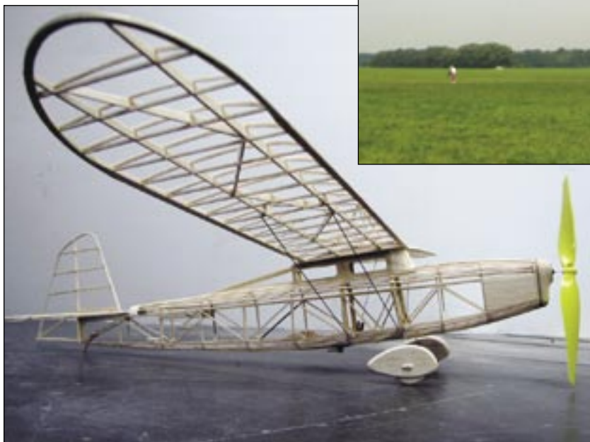
Luc Martin of Montréal shows us 'work in progress' on his Rene Leduc RG-16 42" span for Jumbo Scale. Outstanding structure and workmanship. / Luc Martin, de Montréal, montre où il en est rendu avec son René Leduc RG-16. Envergure de 42 pouces pour la catégorie Jumbo Scale. Structure et savoir-faire absolument sans reproche.
