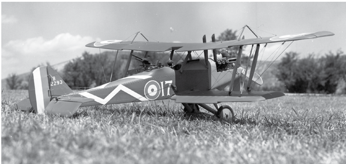
A gorgeous RE-8 World War I two-seater. It was built around 1975 by Gord Gimbert, and it was an excellent flyer. Fox .35 engine with Roberts throttle control system using an exhaust slide. / Un magnifique chasseur RE-8 biplace de la Première Guerre mondiale. Gord Gimbert l'a construit vers 1975 et l'avion volait très bien. Il était doté d'un moteur Fox .35 et d'un système Roberts de gestion des gaz.
