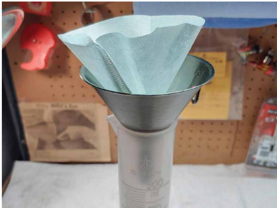
Final fuel mixes are poured into the end user container through a coffee filter paper or equivalent. / Votre mélange final est tamisé à travers un filtre à café (de papier) ou quelque chose d'équivalent.
