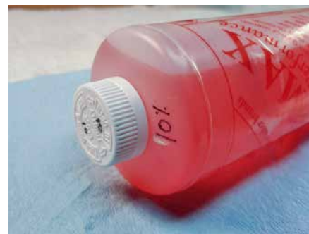
Laying your fuel container on its side over a paper towel is a simple method of determining if you have a leaky fuel cap or not. / Couchez votre contenant de carburant sur le côté sur un essuie-tout. C'est une méthode toute simple de déterminer si votre bouchon est hermétique ou non.
