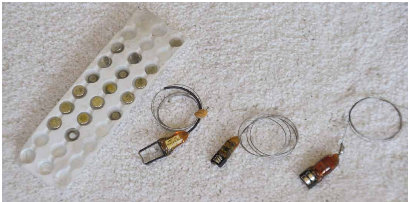
Three transmitters with batteries of different ranges and weights. In free flight, that small weight difference can be significant. All of my transmitters are on the same frequency, and are different from other flyers. / Trois émetteurs avec batteries de diverses portées et divers poids. En vol libre, même les petites différences de poids sont importantes. Tous mes émetteurs fonctionnent sur la même fréquence et diffèrent de celles des autres modélistes.
