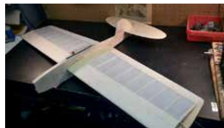
Here, the Polyspan has been heat shrunk & edges trimmed. / Ici, le Polyspan a été rétréci et j'ai découpé le surplus. Photo by Paul Gibeault
