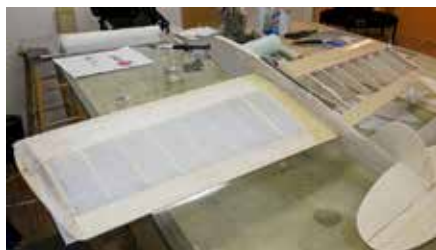
Shown here, the first wing panel with Polyspan has gone on quite nicely. / On voit ici que le Polyspan a été appliqué sans difficulté sur un premier panneau. Photo by Paul Gibeault
