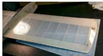
Finished! The SLC covering goes on very easily over the bare Polyspan. / Terminé! Le recouvrement SLC s'applique très aisément sur le Polyspan à nu. Photo by Paul Gibeault
