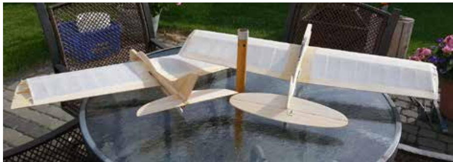
Both Flite Streak and Ringmaster are drying outside after the Polyspan has been applied. / Le Flite Streak et le Ringmaster ont été placés à l'extérieur, le temps de sécher une fois le Polyspan appliqué. Photo by Paul Gibeault
