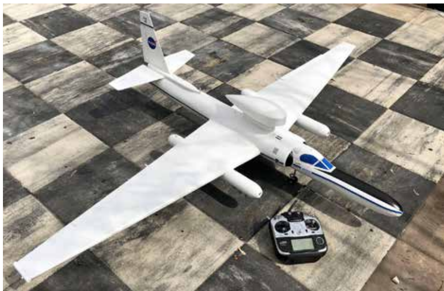
My 100% scratchbuilt NASA ER-2. It has an 80" wingspan and weighs 4lbs ready to fly. It is powered by two 25 amp motors spinning APC6x4 pusher props, one on each wing pod. Two 2200Mah 3S packs give a run time of about 15 minutes. The Pod on top is removable and houses a Go-pro or FPV camera. What is inside the long nose is a secret. / Mon ER-2 de la NASA, de construction 100 % artisanale. Il possède une envergure de 80 pouces et pèse 4 livres, prêt à voler. Deux moteurs de 25 ampères le propulsent à l'aide d'hélices propulsives (pusher) APC 6 x 4, l'une dans chaque nacelle (pod) d'aile. Deux batteries 3S de 2 200 mAh me procurent un temps de vol d'environ 15 minutes. L'ajout sur le dessus est amovible et renferme une caméra Go-Pro ou de vol par immersion (FPV). Ce qui se trouve dans le nez allongé... c'est un secret.
