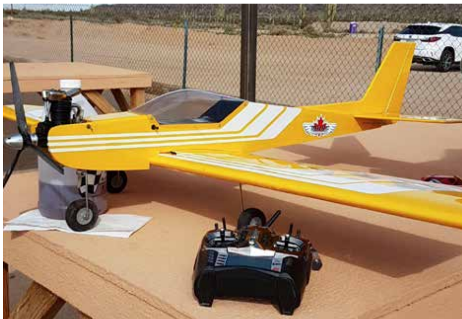
Brian Whitehead's Tiger 60 on January 1. It has a Saito 65 with a 3 blade 12 X 6 Master Airscrew. This photo was taken at Casa Grande, Arizona. / Le Tiger 60 de Brian Whitehead, le 1er janvier. Il est mû par un Saito 65 avec hélice tripale Master Airscrew de 12 X 6. Photo croquée à Casa Grande (Arizona).
