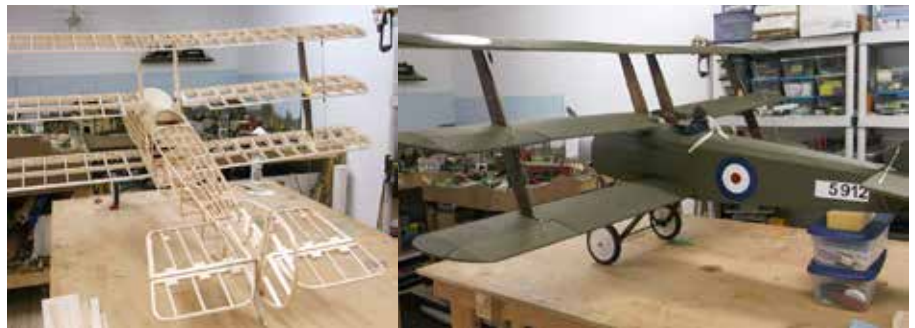
Gene Saffran's almost finished 89-inch wingspan Sopwith Triplane, powered by a G-38, before and after covering. / Le Sopwith Triplane presque terminé de Gene Saffran. Envergure de 89 pouces et mûe par un G-38. Photos d'avant et après avoir appliqué le recouvrement.
