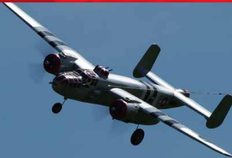
B-25 Mitchell on final at the Leduc flying field. The model has a 52-inch span and is powered by two OS 55s. / Un B-25 Mitchell en finale au terrain de Leduc. La maquette possède une envergure de 52 pouces et est mûe par deux O.S. 55.
