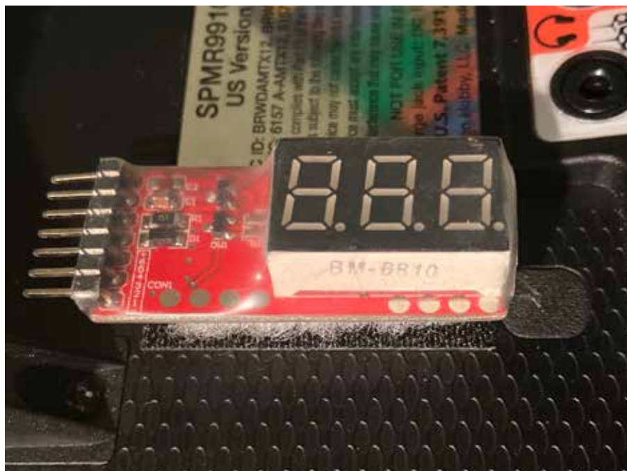
A cheap, simple voltmeter Velcro'd onto the transmitter for easy checking of the battery. / Ce voltmètre a été fixé à l'émetteur à l'aide d'une simple bande de Velcro, de sorte à ce que vous puissiez vérifier la batterie à tout moment.
