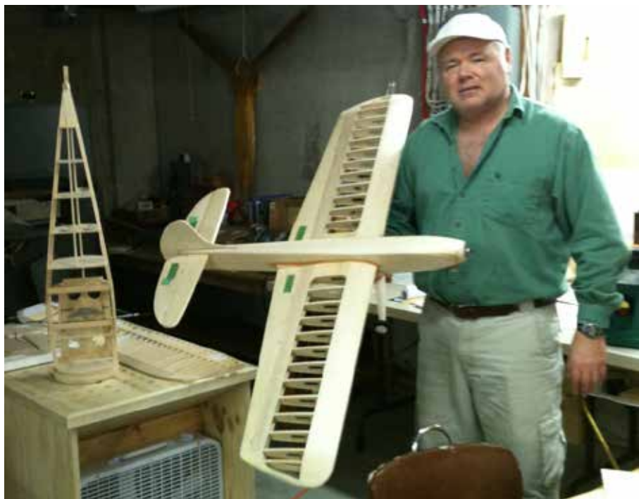
Paul Gittel with Dee Rice-designed Oriental ready for paint. / L'Oriental de Paul Gittel (un design de Dee Rice) est prêt pour la peinture.
