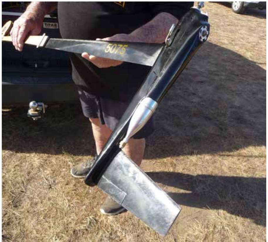
John's all-carbon FAI F2A Profi .15 powered speed model. / La maquette tout-carbone de John pour la vitesse FAI F2A. Motorisation : Profi .15.
