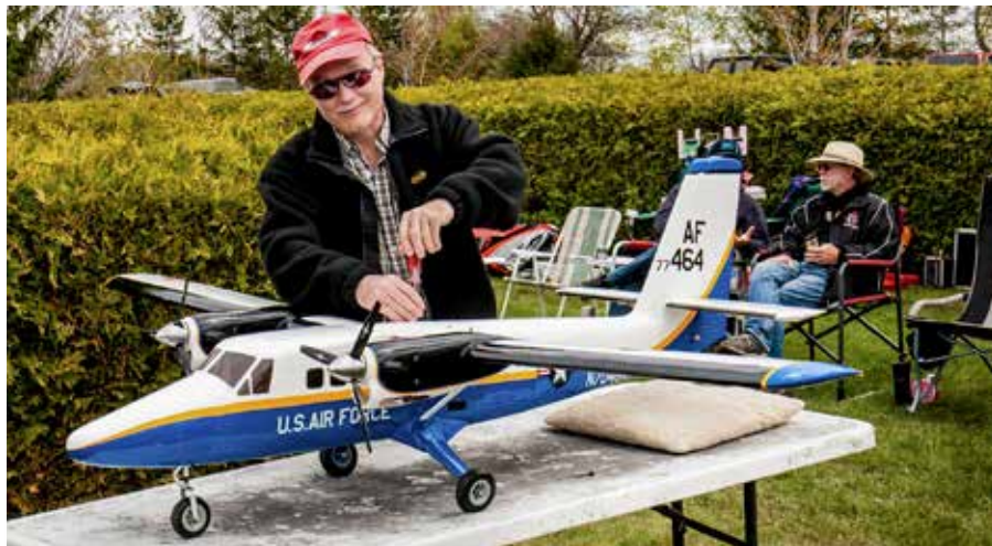
Twin Otter by Richard Lee of the Arnprior club. Hangar 9 kit converted to electric. EFlite Power 32 motors, two 4s 4000 mAh LiPo batteries. / Le Twin Otter de Richard Lee au Club d'Arnprior. Il s'agit d'un kit de Hangar 9 converti à la propulsion électrique. Moteurs Power 32 d'EFlite, deux batteries LiPo 4s de 4 000 mAh. Photo: Larry Ingram
