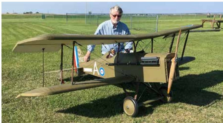
Art Irwin's 1/3 scale SE5a. Wing span 108", DLE 85cc engine, prop 28x10, weight 60 lbs. Flown by RCAF pilot Fred McCall with 37 confirmed kills in WWI. / Le biplan SE5a à l'échelle 1/3 d'Art Irwin's. Envergure de 108 pouces, moteur DLE de 85 cc, hélice 28 X 10, poids de 60 livres. La maquette reproduit l'appareil à l'échelle réelle que pilotait Fred McCall pendant la Première Guerre mondiale. M. McCall avait 37 victoires aériennes à son actif.
