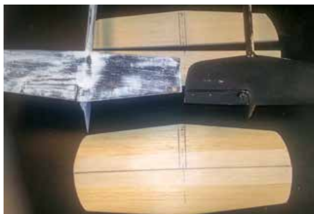
Three model stabilizers with sewn hinges: Bare wood, with primer and painted with one coat of epoxy. (invisible). / Trois stabilisateurs munis de pentures cousues : le bois dénudé enduit d'apprêt et peint d'une couche d'époxy (invisible).
