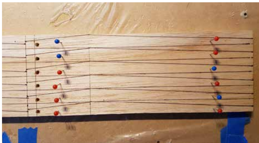
Fuse sticks marked out on a sheet of 1/8" balsa. / Les bâtonnets qui composent le fuselage sont marqués sur une feuille de balsa 1/8 de pouce.
