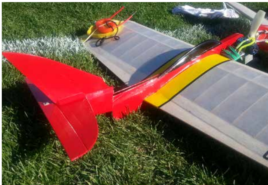
After another full power straight-in crash, this fuselage broke but not the hinges! / Après un autre écrasement à plein régime, le fuselage s'est cassé, mais pas les pentures! (La finition est une couche de peinture epoxy sur du bois dénudé, sans même de l'apprêt.)
