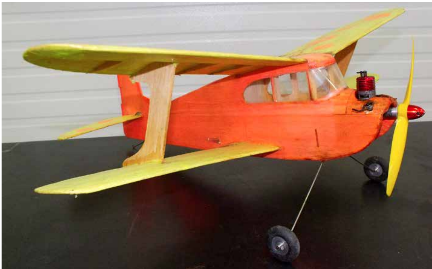
Frank Klenk's free flight biplane at a 23-inch span and 278 grams ready to go, a refreshed Davies Charlton 1.5 Sabre diesel for nose weight. / Le biplan de vol libre de Frank Klenk. Envergure de 23 pouces et poids prêt à voler de 278 grammes. Un moteur diesel 1.5 Sabre (de Davies Charlton) le propulse.
