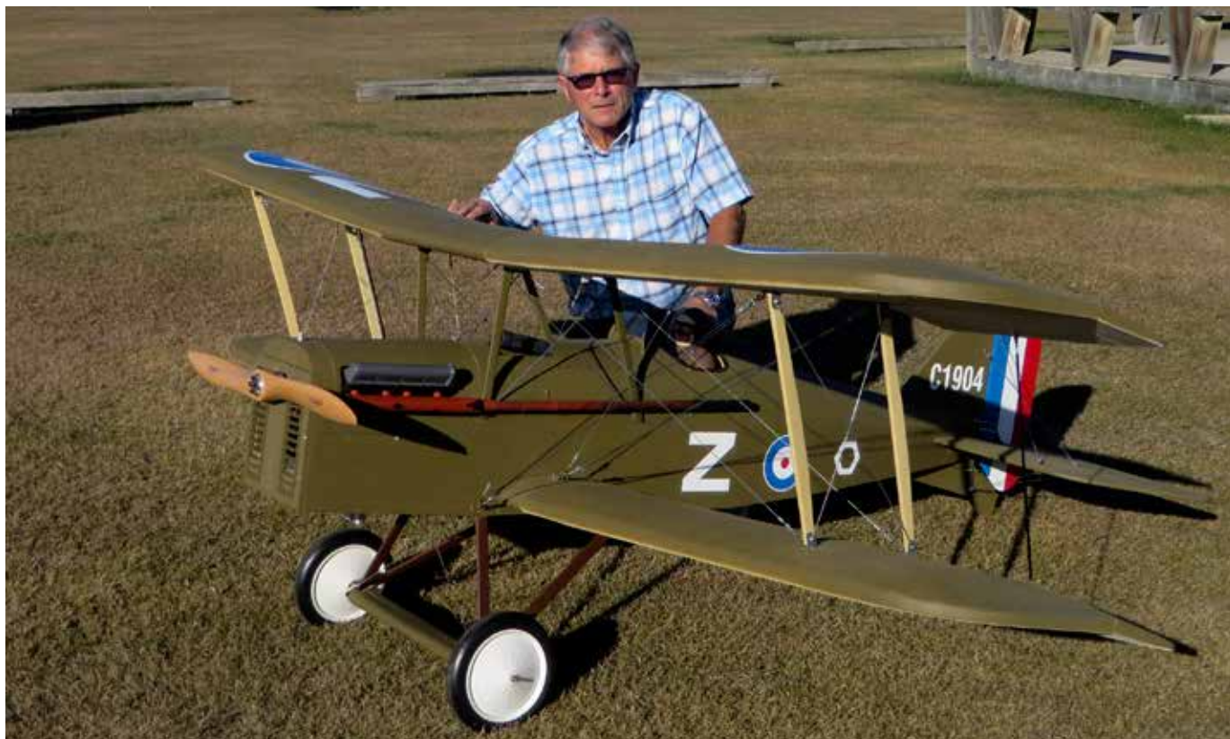
RAF SE5a built from plans by Brian Irwin, a member of Calgary's Stampede City Radio Control Model Club. The biplane has a 108-inch wingspan (1/3 scale) with a DLE 85cc driving a 28 X 10 prop. It is done up in the markings of Billy Bishop, Canadian Ace during WWI. First flight was October 17, 2018. / Le biplan SE5a qu'a construit Brian Irwin (Stampede City Radio Control Model Club de Calgary) à partir d'un jeu de plans. Celui-ci possède une envergure de 108 pouces (échelle 1/3), est mû par un DLE de 85 cc et fait tourner une hélice de 28x10. La livrée est une reproduction de l'appareil de l'as de la Première Guerre mondiale, Billy Bishop. Le premier vol s'est déroulé le 17 octobre 2018.
