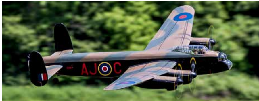
Electric RC on a big scale. Chris Malcolmson's scratch-built 134" (3.4 m) span Dam Buster Lancaster. Weight 33 lb (15 kg) with four 5S 5000 mAh batteries. Design by Tony Nijhuis. / Maquette électrique à échelle géante. Le Lancaster de construction artisanale de Chris Malcolmson, en livrée des célèbres Dam Busters. Envergure de 134 pouces (3,4 mètres), poids de 33 livres (15 kg) avec quatre batteries embarquées de 5 000 mAh 5S. Design de Tony Nijhuis.
