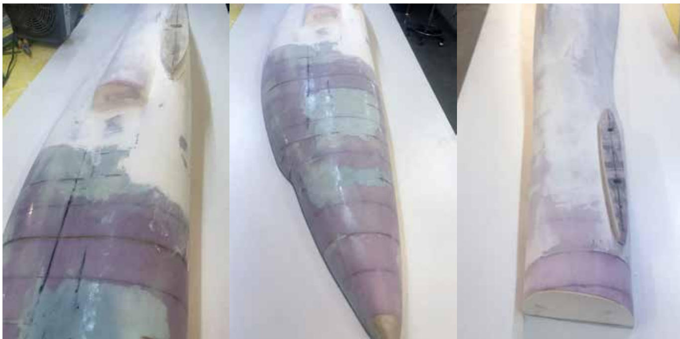
Progress on Harold Sattler's turbine fuselage mold. / Du progrès : le moule du fuselage de maquette à turbine de Harold Sattler.
