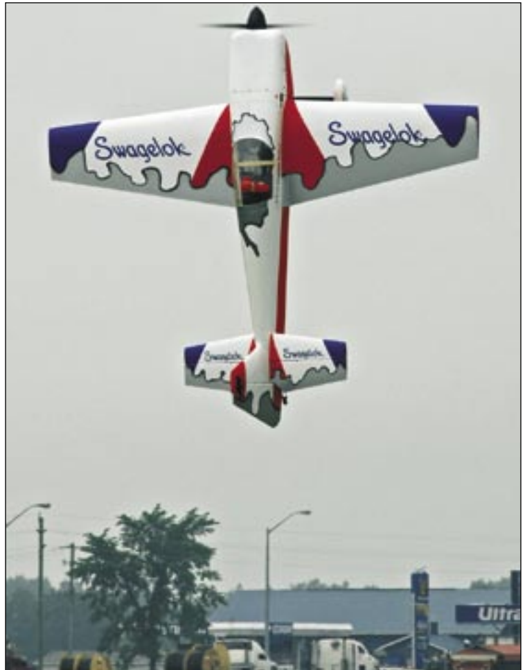
Sébastien Lajoie from Sainte-Julie, Québec, shows his 3D skills with his dramatically finished Extra 260. This 119-inch span plane was powered with a DA-150. / Sébastien Lajoie, de Sainte-Julie (Québec), montre ses talents au vol 3D à l'aide de son resplendissant Extra 260. Cet avion d'une envergure de 119 pouces était mù par un DA-150.
