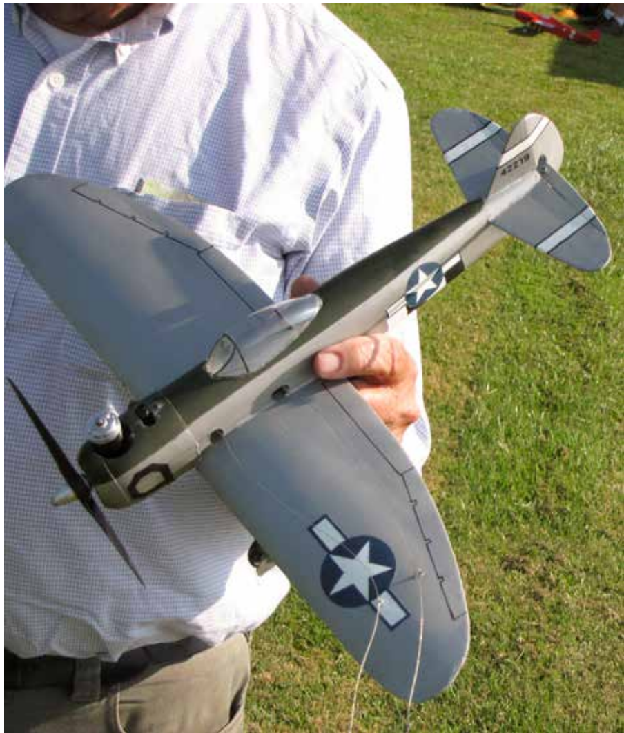
Keith Morgan's retro copy of a Topflite P-47 Thunderbolt, a popular 1/2A (.049) kit in the 1960s & 1970s. It flies well, and will even loop! Powered by Cox Babe Bee .049, flown on 30 ft. Spiderwire lines. / La reproduction rétro de Keith Morgan, un P-47 Thunderbolt (de Topflite). C'était un kit 1/2A (pour moteurs .049) très populaire au cours des années 1960 et 1970. Motorisation : Cox Babe Bee .049 et piloté grâce à des filins Spiderwire de 30 pieds.
