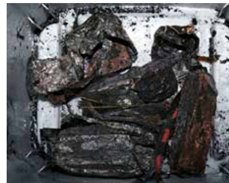
What is left of a Li-Po battery after a crash - it blew apart when the plane crashed. / Ce qui reste d'une pile Li-Po après un accident. Elle s'est désintégrée après l'écrasement de l'avion.
