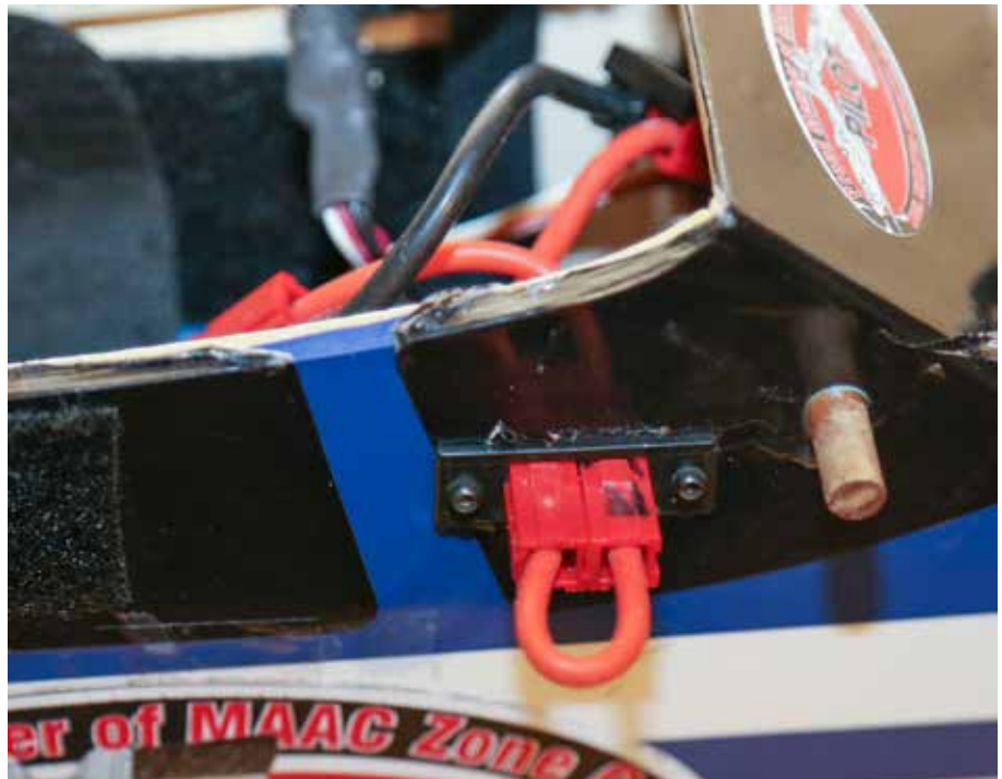
This arming plug uses commonly available power pole connectors. / Cette prise d'armement utilise des connecteurs colonnettes d'alimentation (power pole connectors) communément disponibles.
