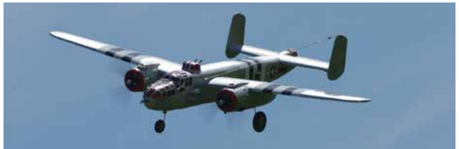
A 68-inch span B25 Mitchell on final approach at the LARCS flying field. Power by two O.S. 55s. / Un B-25 Mitchell (envergure de 68 pouces) en finale au terrain du Club LARCS. Motorisation : deux O.S. 55. Photo by Mario De Rocco.
