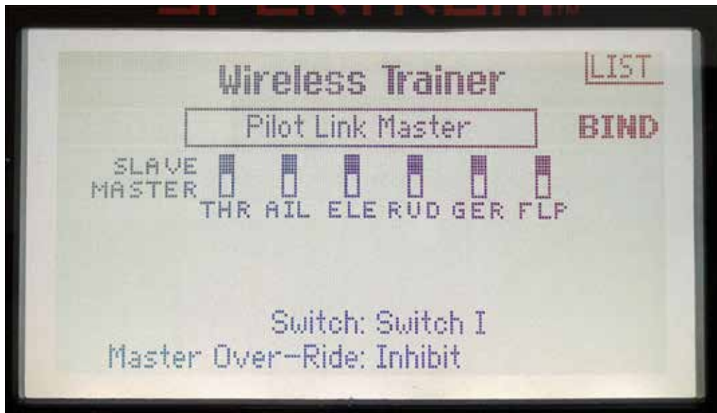
This is what the wireless training screen of a Spektrum radio should look like when it is configured. / Voici ce dont devrait avoir l'air l'écran d'un émetteur Spektrum en mode formation sans fil, une fois configuré.
