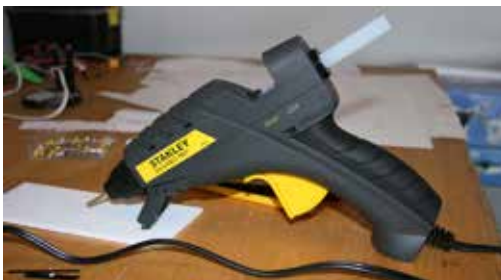
The perfect glue gun – a Stanley DualMelt Pro – note the folding stand. / Le fusil à colle parfait – le Stanley DualMeltPro – notez le support pliant.
