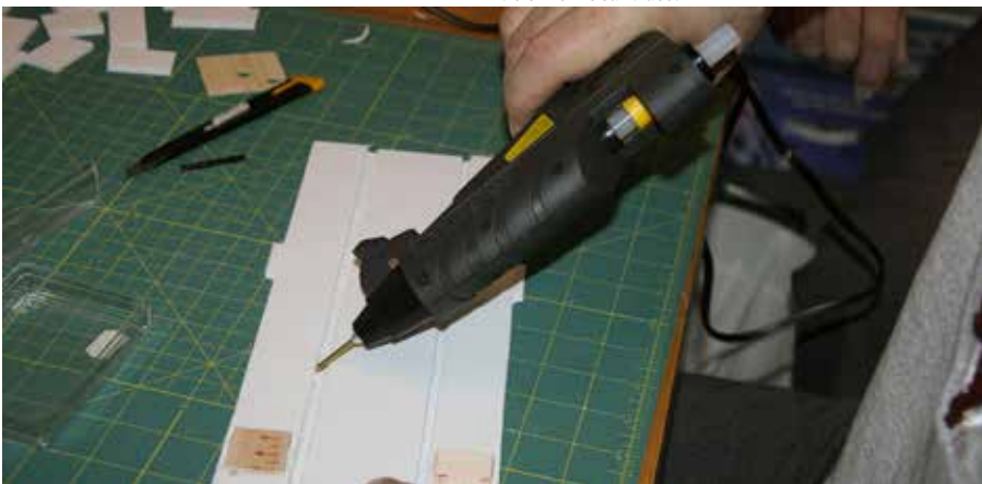
Note the fine tip nozzle and the hardwood plate modification to the plan which replaces wood skewers with screws. / Notez l'embout très fin et la modification au plan (une plaque de bois dur) qui remplace les bâtons de brochette par des vis.
