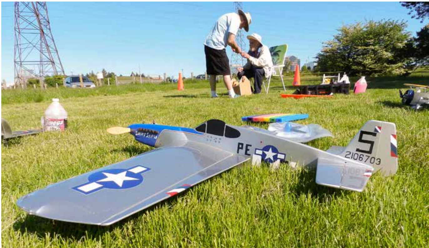
Naomi Macklem's Brodak P-51 Profile Scale model at last year's Toronto & District Championship held in June. The engine is an O.S. LA .46 with Spread Spectrum radio doing the motor control. The model has an approximately 52-inch span, weighs about 50 oz and is a nice flyer that handles the wind well. / La maquette de style profil du P-51 (un kit de Brodak) de Naomi Macklem au cours du championnat de district de Toronto, en 2017. Le moteur est un O.S. LA .46 que contrôle un émetteur Spektrum 2.4. La maquette est dotée d'une envergure d'environ 52 pouces, pèse environ 50 onces et se débrouille très bien dans le vent!
