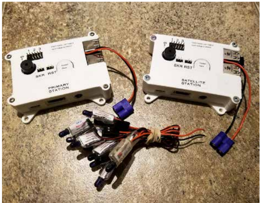
EasyRaceLapTimers with IR transmitters. / Les chronomètres de piste EasyRaceLap, munis d'émetteurs IR.
