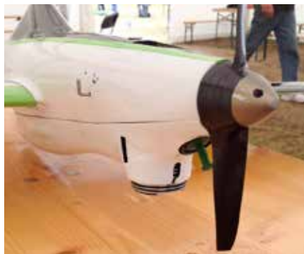
This is the World Championship aircraft from the Czech Republic. This shows air intake ducting (along the side of the cylinder) that directs cool air directly to the header region of the tuned pipe. Also note the inlet duct on the top of the fuselage just over the engine. / Voici un appareil en provenance de la République Tchèque. On aperçoit la canalisation de l'air (le long du cylindre) qui dirige l'air froid directement au collecteur du tuyau d'échappement calibré. Notez aussi la canalisation sur le dessus du fuselage, juste au-dessus du moteur.
