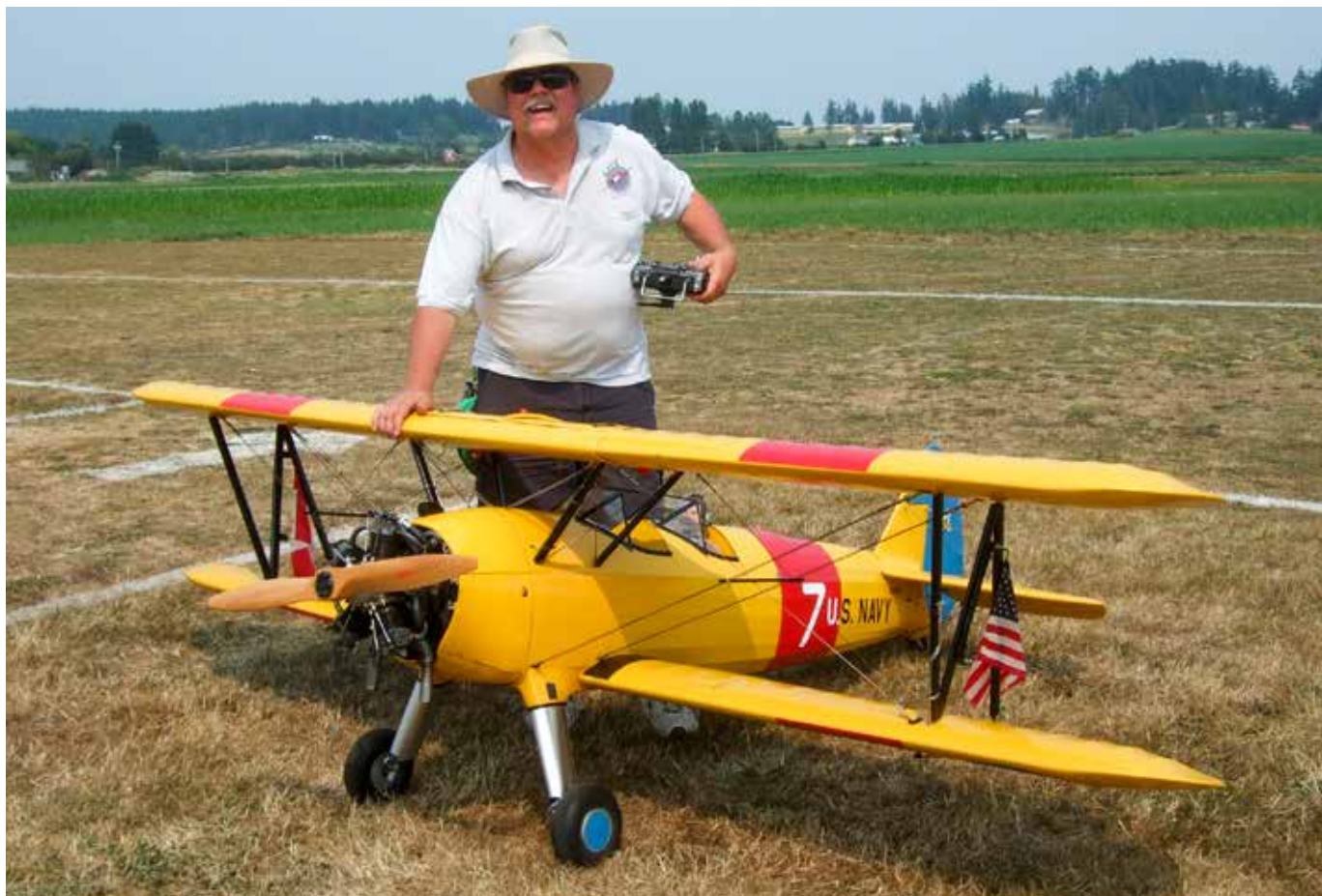
Scott Davis with his "Absolutely Amazing" 1/3 Scale Balsa USA Stearman at the 2017 VRCMS "Largest Little Airshow." The model is powered by a Moki 250cc five-cylinder radial engine that powers the model effortlessly, and puts on one of the best "smoke" displays I've ever seen. Scott pilots this model through a Scale Aerobatic routine beautifully. Scott is from Salt Lake City, Utah. / Scott Davis et son merveilleux Stearman à l'échelle 1/3 (un kit de Balsa USA) au Largest Little Airshow du Club VRCMS, édition 2017. Cette maquette est mue par un Moki à cinq cylindres de 250 cc et son pilote effectue l'une des meilleures routines de fumée qu'il m'ait été donné de voir. Scott sait vraiment exécuter une routine acrobatique réaliste. Scott nous arrivait de Salt Lake City (Utah). (Photo: Bill Rollins)
