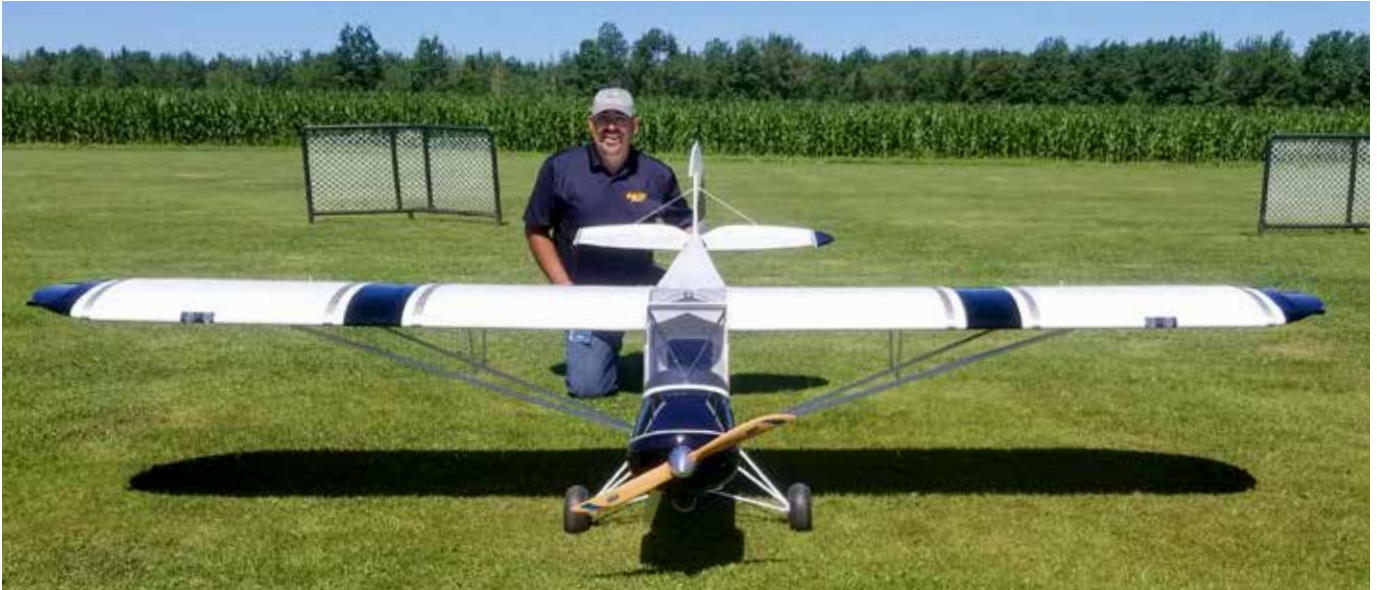
Sébastien Dontigny's 1/3 scale Super Cub made from a Balsa USA kit, powered by a EME 70cc twin cylinder engine. / Le Super Cub à l'échelle un tiers de Sébastien Dontigny (depuis un kit de Balsa USA), mû par un EME bicylindre de 70 cc.
