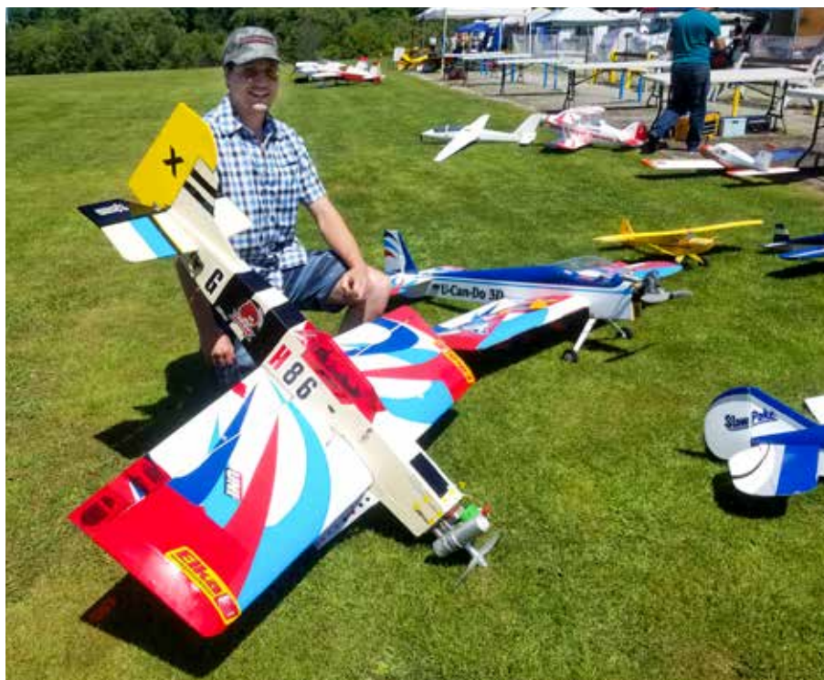
Richard Babin, from the CARC Club, shows his homemade model with a fuse based on measurements from a P-51 Mustang, a wing from a U CAN DO, and a motor modified from G 26 helicopter. / Richard Babin, du Club CARC, montre sa maquette de fabrication artisanale : fuselage basé sur les dimensions d'un P-51 Mustang, des ailes provenant d'un U CAN DO et un moteur modifié d'un hélicoptère G 26
