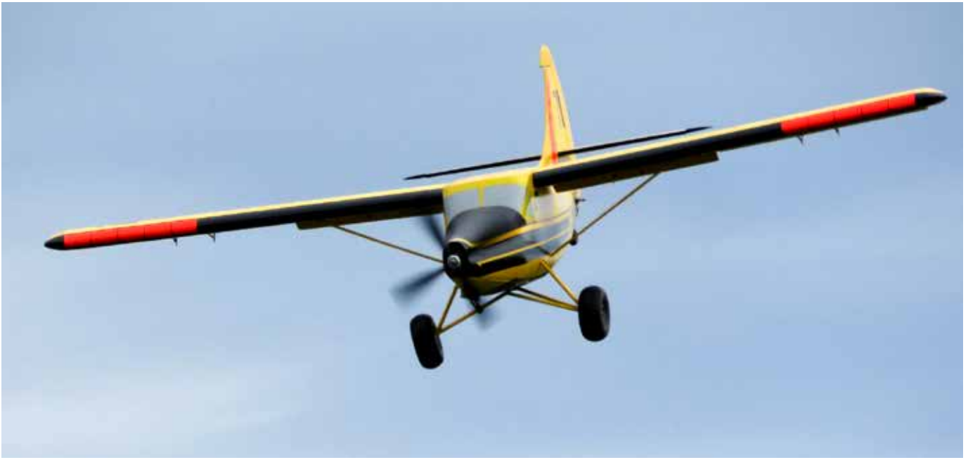
Nathan Crosby's turbo Otter with flaps down getting ready for a short-field landing. / L'Otter turbo de Nathan Crosby s'aligne vers un atterrissage de courte piste, tous volets déployés.
