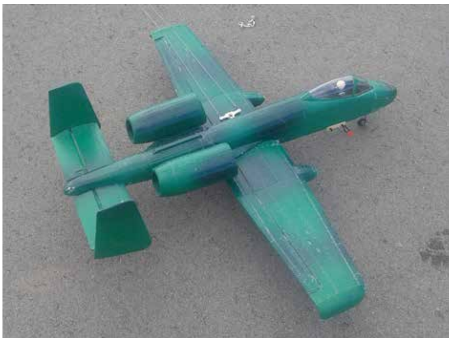
Stuart Henderson's Warthog is a foam kit designed for R/C but converted to Control Line with two GSW ducted fan electric motors. / Le Warthog de Stuart Henderson est un kit de mousse destiné au vol télécommandé, mais il l'a modifié pour le vol circulaire et a installé deux petits moteurs GSW.
