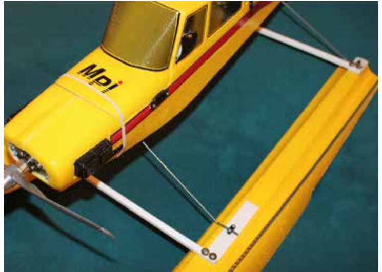
My Fun Cub showing fore and aft spreader bar attached to float bearing plates. Mon Fun Cub muni des barres d'espacement qui sont fixées aux plaques d'ancrage des flotteurs.
