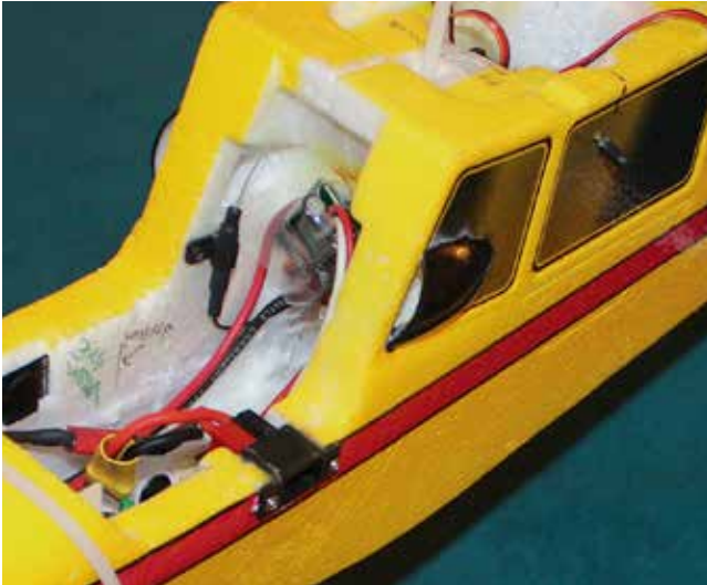
Air inlet scoops on sides of cabin, with speed controller beside port scoop. Les prises d'air sur les flancs du fuselage. Le contrôleur de vitesse se trouve à babord.
