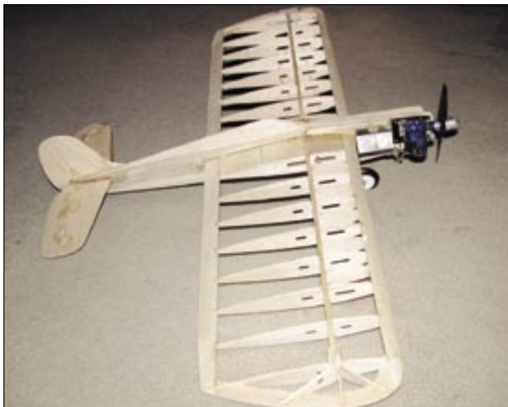
LA .25 Sport Racer built by Chris Brownhill from a vintage Goldberg C/L Kit. O.S. LA .25 engine, single wheel undercarriage, adjustable lead-out guide. / Un maquette LA .25 Sport Racer, de Chris Brownhill, assemblée grâce à un vieux kit de Carl Goldberg. On y retrouve un moteur O.S. LA .25, un terrain d'atterrissage à roue unique ainsi qu'un guide lead-out ajustable.
