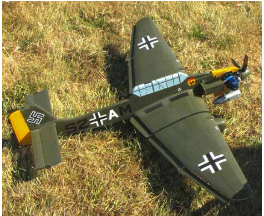
Dave Kelly's superb Profile Scale Stuka, with O.S. 40FP engine, Roberts 3-wire throttle control system. It won second place at the Niagara C/L Scale event held July 23, 2016. Nice workmanship, and an excellent flier! / Le superbe Stuka (profil) de Dave Kelly. Moteur O.S. 40 FP, système des gaz Roberts à trois filins. Cette maquette a obtenu la deuxième place lors du concours de vol circulaire de Niagara, le 23 juillet 2016. Très beau travail de modélisme et cet appareil vole superbement!
