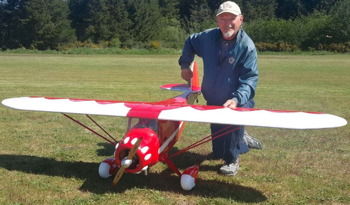
Barry Buryniuk's Kangke Models Monocoupe 90A, powered by a 26cc CRRC gas engine, 96-inch wingspan, it weighs in at 16 pounds and is a wonderful flying aircraft. Photo by Bill Rollins / Le Monocoupe 90A de Barry Buryniuk (un kit de Kangke Models). Cette maquette est mue par un moteur à essence CRRC de 26 cc, l'envergure est de 96 pouces et le poids est de 16 livres. Cet avion vole merveilleusement bien. Photo de Bill Rollins
