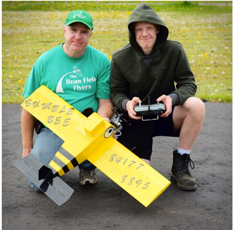
The Bumble Bee, a Control Line endurance model designed by Doug and Daniel Blackmore for their successful record attempt. Power is a LA .15 with throttle. Weight is 4 lbs with fuel load. Photo Courtesy of Sara Ricketts - Ninjatography / Le Bumble Bee, une maquette de vol circulaire d'endurance qu'ont dessinée Doug et Daniel Blackmore afin de s'attaquer à un vieux record. Motorisation : O.S. .15 LA muni d'un dispositif des gaz. Poids : 4 livres (une fois le carburant versé). PHOTO : gracieuseté de Sara Ricketts /Ninjatography
