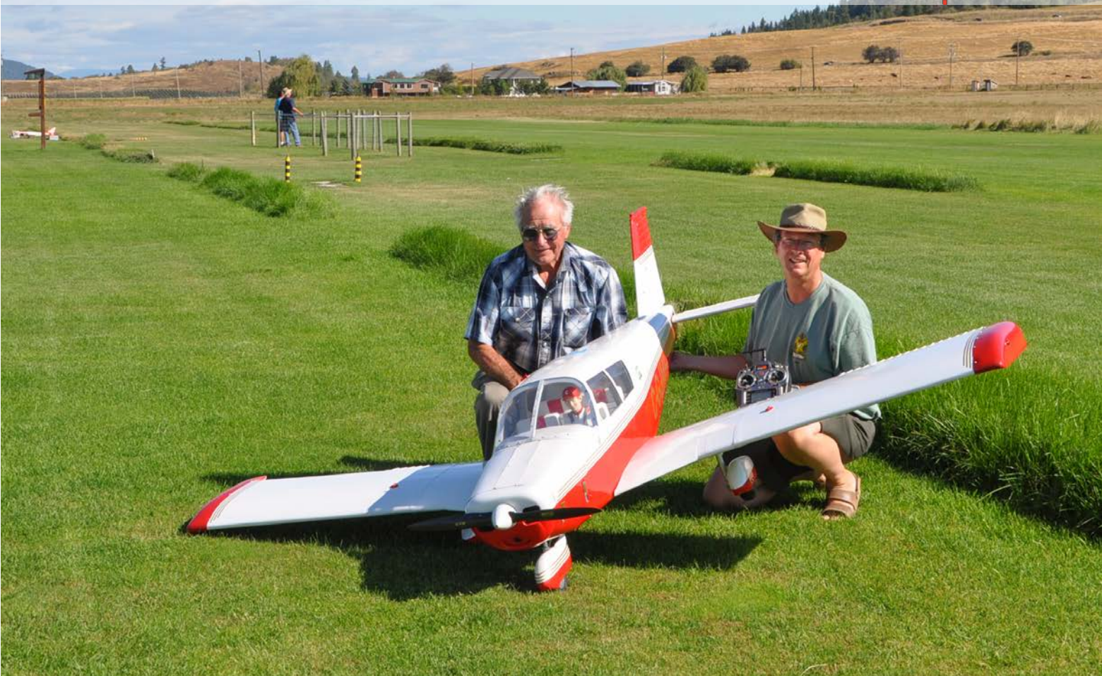
Team Scale – 2015 North West Scale Aero-Modeling Championships -- Team Scale Champions Dan Idorn (builder) and Rob Dover (Pilot). Dan scratch built the 1/3 scale electric Piper Cherokee. He built everything himself from his own plans, save for the wheels, motor and some control linkages. / Team Scale lors du Championnat North West Scale Aero-Modeling Championship de 2015. Voici les champions en équipe Dan Idorn (constructeur) et Rob Dover (pilote). Dan a construit de façon artisanale ce Piper Cherokee électrique à l'échelle un tiers. Il a tout construit à partir de ses propres plans, à l'exception des roues, du moteur et de certains raccords de contrôle.
