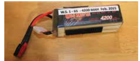
Right: A similar battery in 'as new' condition. / Ci-haut : C'est tout ce qui reste de la batterie Li-Po de six éléments après l'écrasement de mon Edge 540T. À droite : Une batterie semblable, à l'état neuf.
