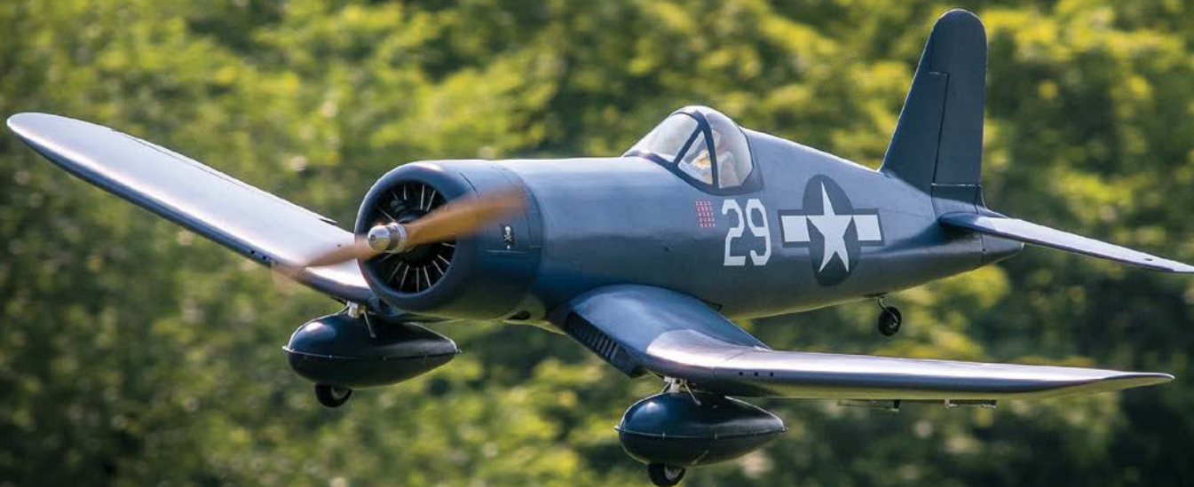
Phil Soden's Expert Scale Corsair winner - Note the wheels hidden in the bottom of the drop tanks. / Le Corsair de Phil Soden, grand gagnant en catégorie des copies volantes Expert. Notez les roues cachées sous les réservoirs largables.
