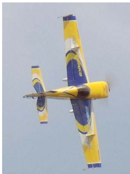
Jamie Skerten's Extreme Flight Edge 540T with a Torque 4016 motor and an Airboss 80-amp ESC. / L'Edge 540T de Jamie Skerten (un kit de Flight Edge). Moteur Torque 4016 et contrôleur de vitesse Airboss de 80 ampères.
