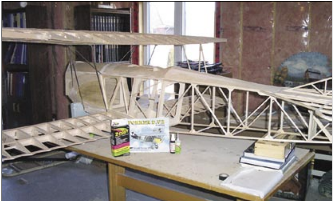
Fokker D.VII, 1/3 scale, made from a Balsa USA kit, wingspan is 118 inches. Engine will be a Zenoah G62 (plane is in the bones). / Un Fokker D.VII à l'échelle 1/3 construit à l'aide d'un kit de Balsa USA. Envergure de 118 pouces. Même si la maquette est à l'étape de cellule squelettique, le moteur prévu est un Zenoah G62.
