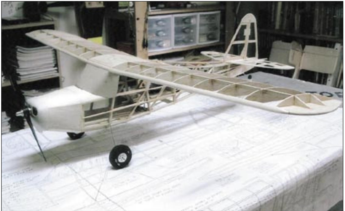
Grant Stephens' 1/10 scale Fleet 80 Canuck enlarged from rubber powered plans. / Le Fleet 80 Canuck à l'échelle 1/10 de Grant Stephen. Les plans de la maquette à élastique ont été agrandis
