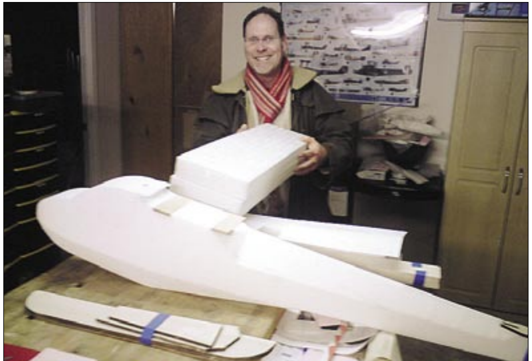
Jacques Des Becquets and his pre-production three-meter EPP Schweizer 2-33 glider. The kit features beautifully cut wing panels, the characteristic chunky fuselage and laser-cut balsa flying surfaces. / Jacques Des Becquets et son kit préproduction en mousse EPP du Schweizer 2-33. Le kit comporte des panneaux d'ailes très bien découpés, le fuselage un peu gras si caractéristique et un empennage de balsa très bien découpé au laser. PHOTO: Gudmund Thompson
