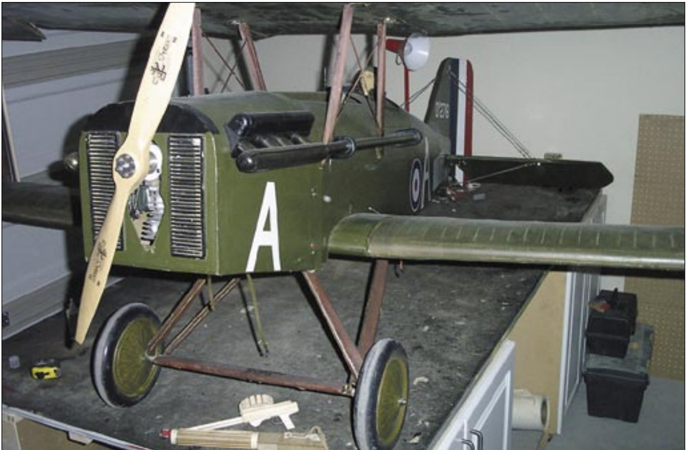
SE5A, scratch-built from [unclear] Un SE5a, construit de façon [unclear] le moteur est un Brison de 95 cc.
