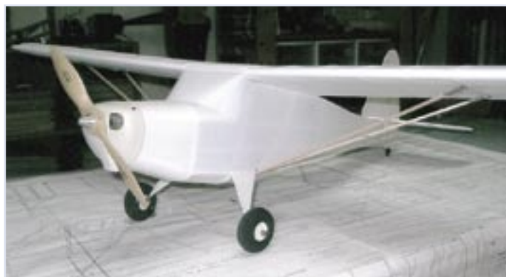
Grant Stephens' 1/10 scale Fleet 80 Canuck enlarged from rubber powered plans. / Le Fleet 80 Canuck à l'échelle 1/10 de Grant Stephen. Les plans de la maquette à élastique ont été agrandis
