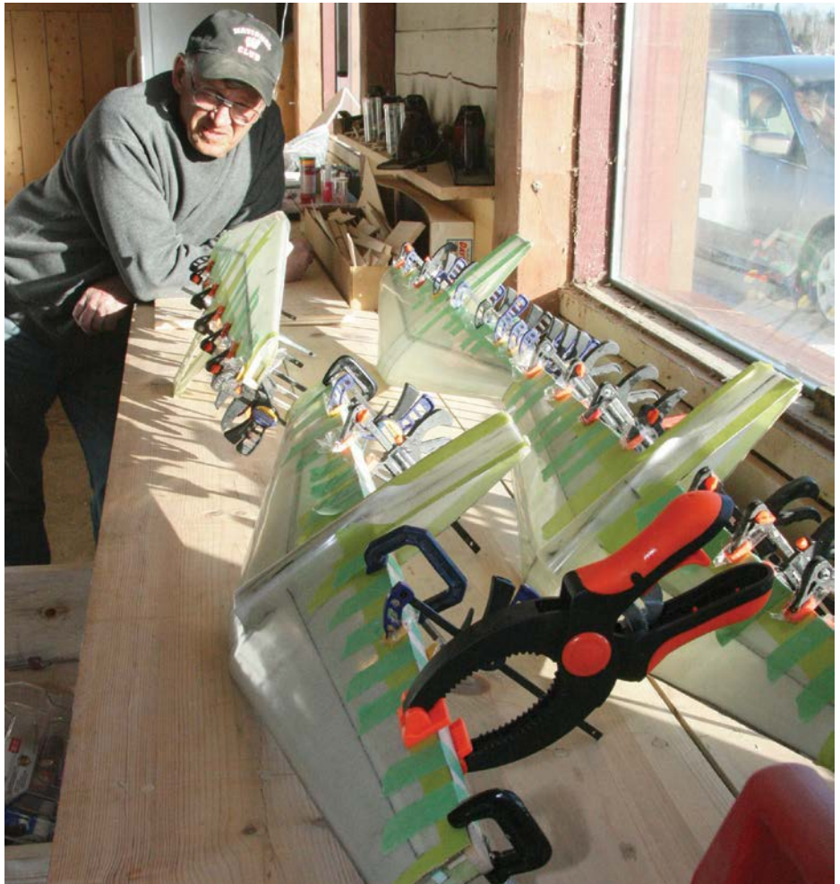
Terry Zilinski with the first four fibreglass horizontal stabilizers, for 8 ¼ scale Chipmunks being group-built in Kenora (Ontario). / Terry Zilinski montre les quatre premiers stabilisateurs horizontaux qui seront installés sur huit Chipmunks à l'échelle un quart qui sont construits en groupe à Kenora (Ontario)
