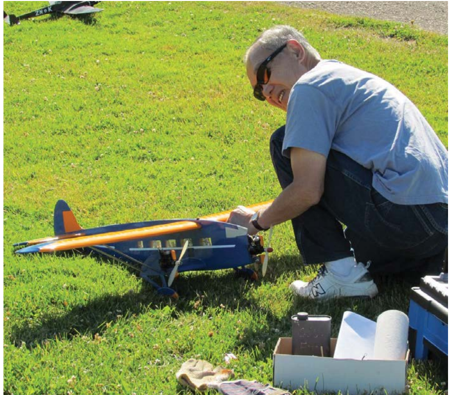
A 1/2A Scale Stinson Trimotor built by Jack Nagao of Toronto. It uses three .049 Babe Bee Engines and has a 32" Span. / Un Stinson Trimotor à l'échelle 1/2A qu'a construit Jack Nagao, de Toronto. Motorisation à l'aide de trois .049 Babe Bee et envergure de 32 pouces.
