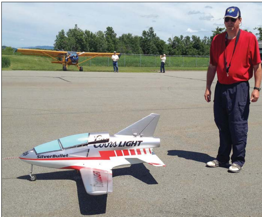
Les ailes de L'aigle Montmagny L'islet President Marc Coulombe and his Coors Light silver bullet BD-5J, powered by a Jetcat P-100 rx turbine. / Marc Coulombe, président du Club Les Ailes de l'Aigle Montmagny-L'Islet, en compagnie de son BD-5J Silver Bullet Coors Light. Cette maquette est mue par une turbine JetCat P100 RX.
