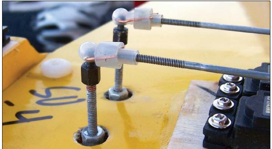
Safety wire connection on aileron torque rods. Refer to RC Pylon column for details. / Les bielles de poussée sont sécurisées à l'aide de du fil de sécurité. Lisez la chronique pour connaître les détails.
