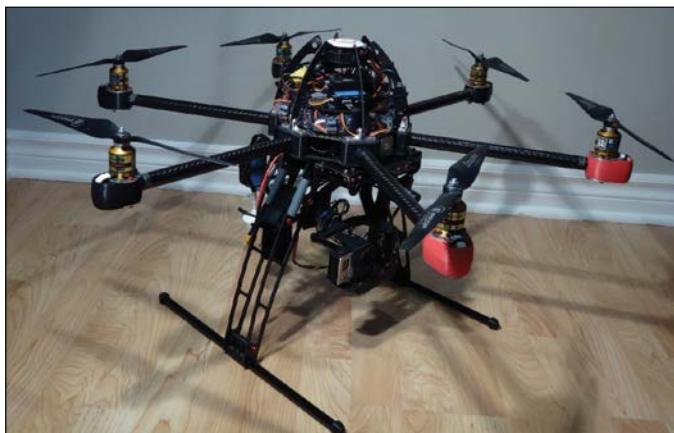
Hexacopter home made in Carbon Fiber with cam stabiliser. Fabricated with a CNC and 3D printer. / Hexacoptere fait maison en fibre de carbone avec stabilisateur de Cam. Fabriqué avec CNC et imprimante 3D Marc Beaudry
