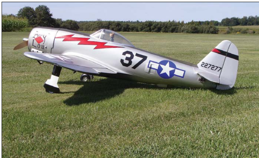
Tom Russell's new P47 Thunderbolt. 85-inch wingspan, DLE 55 engine, weight 20lbs, Futaba 2.4 radio and Robart retracts. Fiberglass with automotive paint. / Le nouveau P-47 Thunderbolt de Tom Russell. Envergure de 85 pouces, moteur DLE 55, poids de 20 livres, système Futaba 2.4 et train escamotable Robart. La maquette a été réalisée en fibre de verre; décoration à la peinture automobile.
