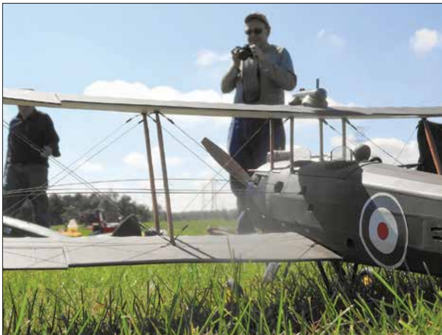
Gord Gimbert's scratch built sport scale Avro 504K powered by O.S. 25 FP engine with a 48" span. Great flyer! / Gord Gimbert a lui-même construit cet Avro 504K (sport scale). Mû par un O.S. 25 FP et doté d'une envergure de 48 pouces. Il vole très bien!
