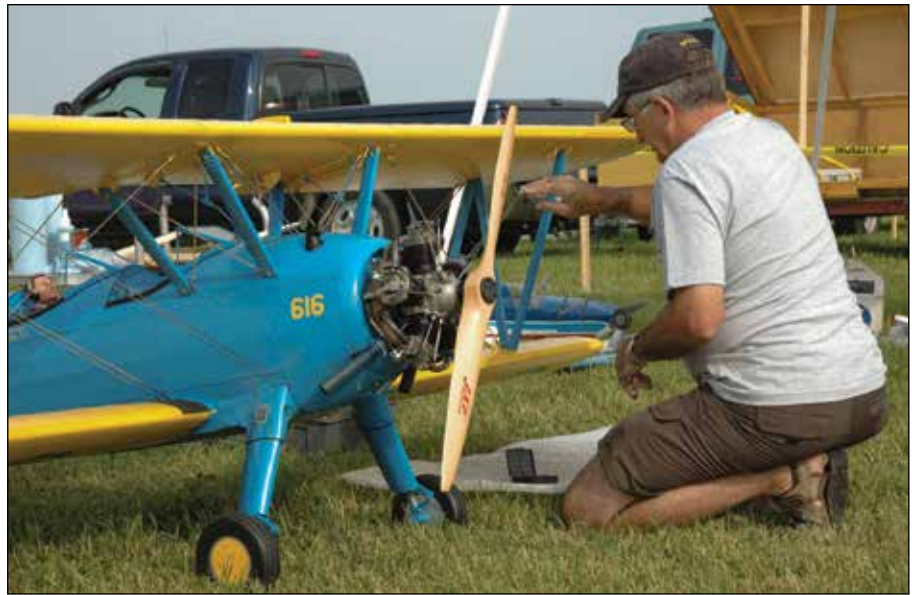
Karl Gross with his 1/3 scale Stearman: it is powered by a five-cylinder gas 250 radial engine. / Karl Gross et son Stearman à l'échelle 1/3, mû par un moteur radial (cinq cylindres) à essence 250.
