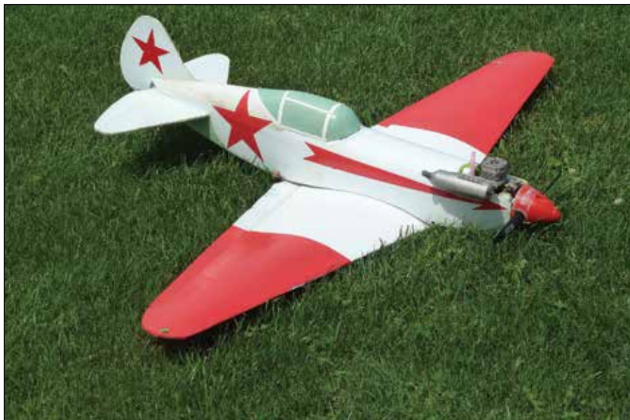
Dave West's 1/12 Scale R/C Combat MiG 7, constructed primarily of corrugated plastic! / La copie volante de combat MiG 7 de Dave West, surtout construite en plastique ondulé!
